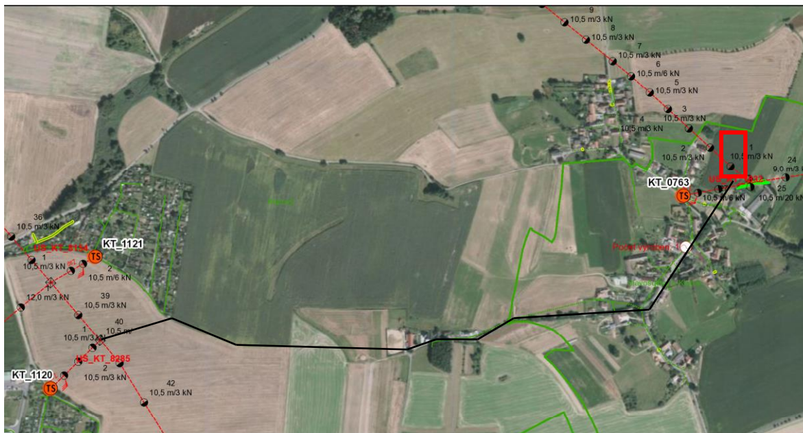
Obrázek 3.1 Trasa kabelu pro připojení FVE [32]
