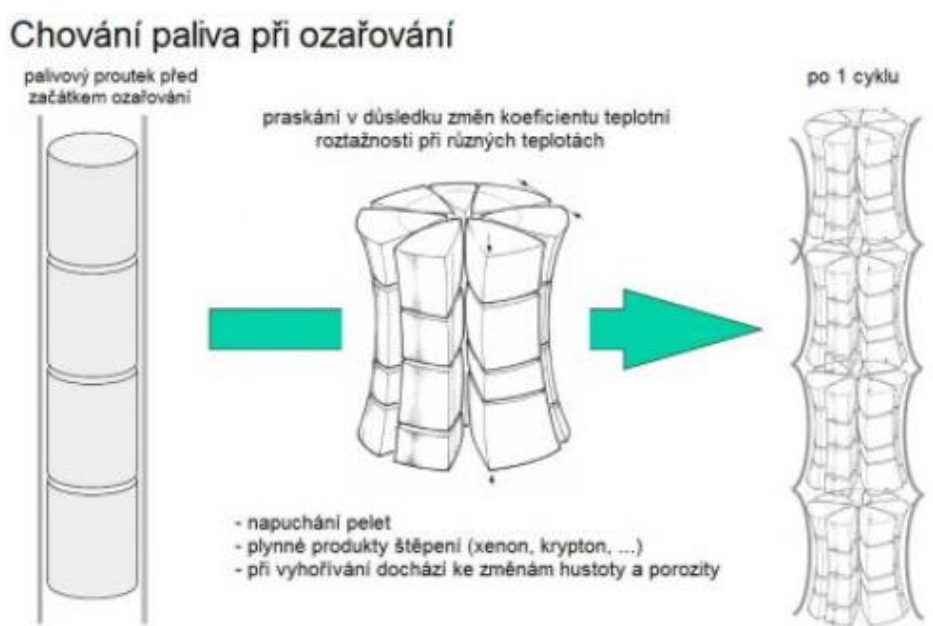
Obr. 2.1: Chování paliva při ozařování [22]
