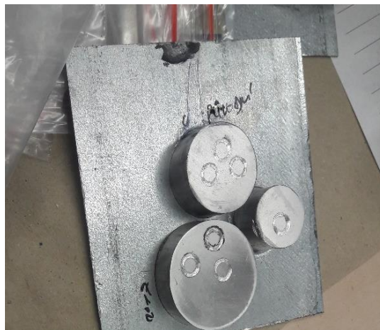
Obr. 51: Slitiny hliníku v základním stavu před nitridací
