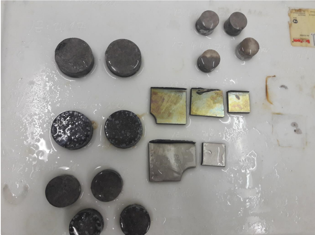
Obr. 58: Slitiny hliníku a titan po korozi (06.05.2021)
