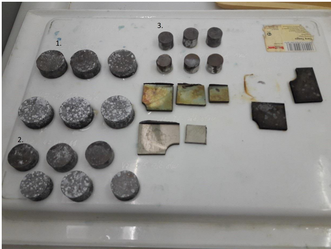
Obr. 57: Slitiny hliníku a titan po korozi (22.04.2021)
