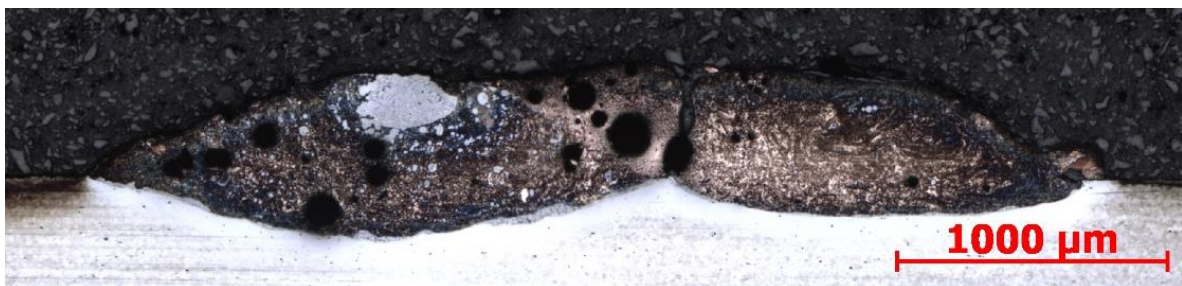
Obr. 19: Vzorek A1; makrosnímek laserového návaru z modrolátkového laseru; leptáno; zvětšeno 25x
