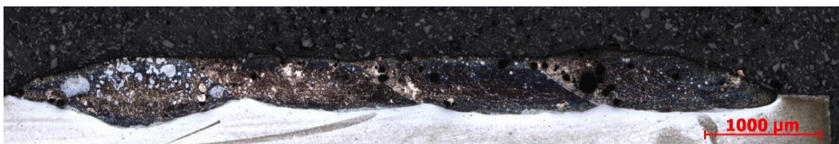
Obr. 20: Vzorek A2; makrosnímek laserového návaru z modrolátkového laseru; leptáno; zvětšeno 25x
