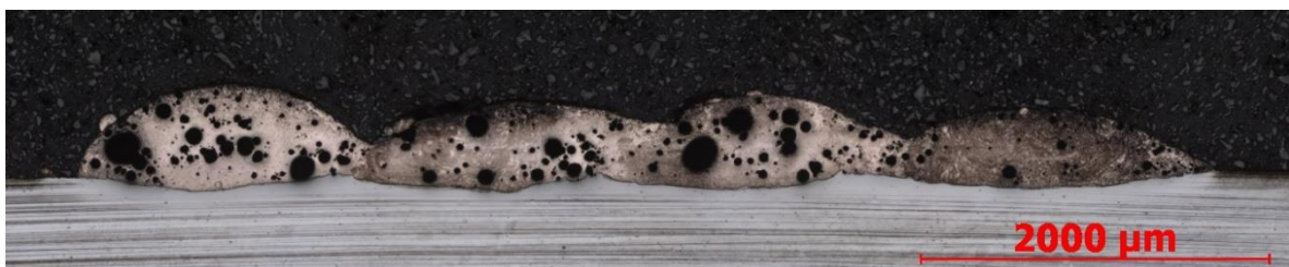
Obr. 21: Vzorek A3; makrosnímek laserového návaru z modrolátkového laseru; leptáno; zvětšeno 25x
