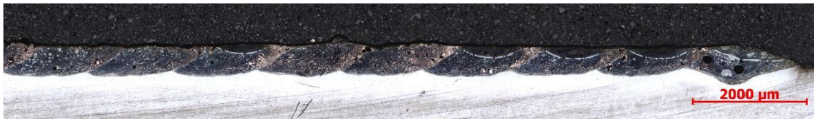
Obr. 22: Vzorek A4; makrosnímek laserového návaru z modrolátkového laseru; leptáno; zvětšeno 25x
