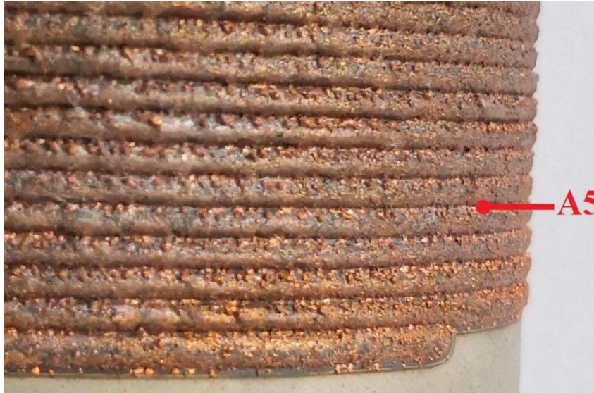
Obr. 79: Vzorek A5 navařený modrolátkovým diodovým laserem LDM blue 1800-60; makrosnímek
