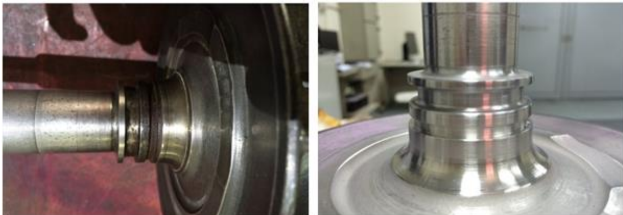
Obr. 6 Opatřovaná těsnicí oblast hřídele turbodmychadla před a po laserovém navařování [29]
