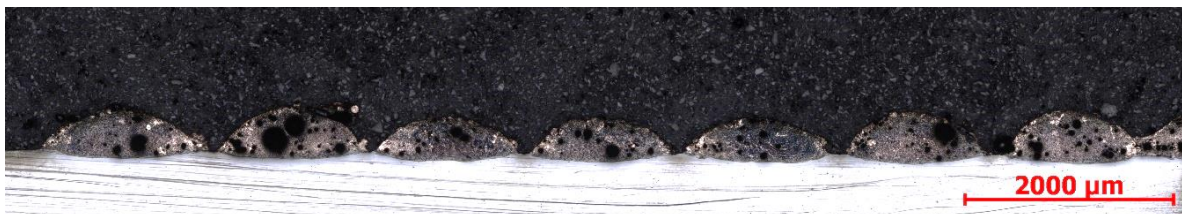
Obr. 23: Vzorek A5; makrosnímek laserového návaru z modrolátkového laseru; leptáno; zvětšeno 25x
