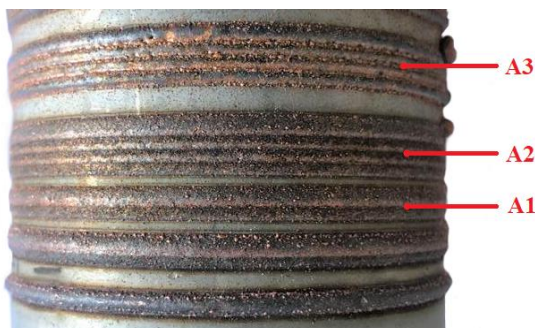
Obr. 15: Vzorky A1; A2; A3 navařené modrolátkovým diodovým laserem LDMblue 1800-60
