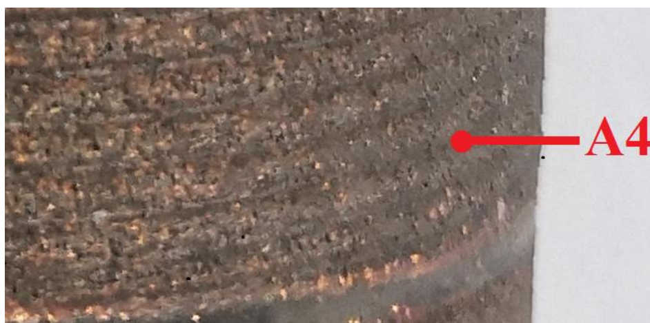
Obr. 78: Makrosnímek vzorku A4 navařené modrolátkovým diodovým laserem LDM blue 1800-60
