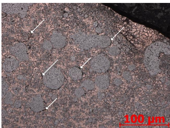
Obr. 59: Vzorek B1; hranice zrn; leptáno; zvětšeno 200x
