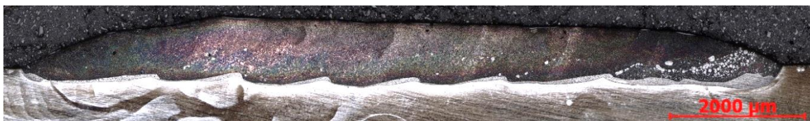
Obr. 25: Vzorek B2; makrosnímek laserového návaru z IR laseru; leptáno; zvětšeno 25x
