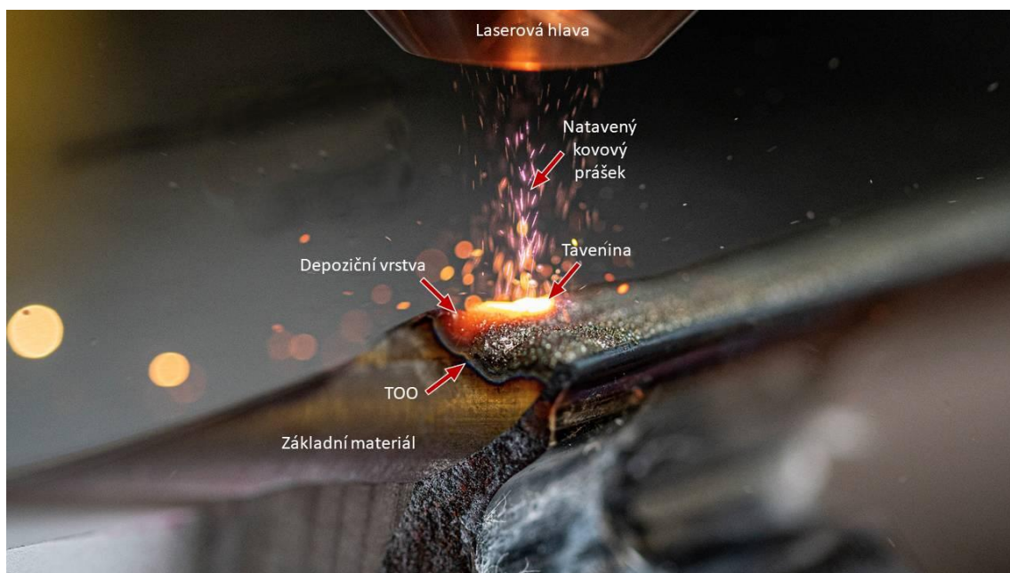
Obr. 1: Princip metody laserového navařování [3]
