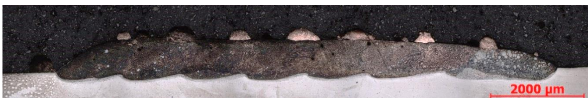
Obr. 24: Vzorek B1; makrosnímek laserového návaru z IR laseru; leptáno; zvětšeno 25x
