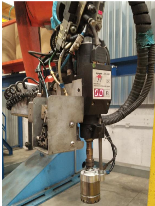
Obrázek 51: Hodnota zanoření ve výchozím stavu
