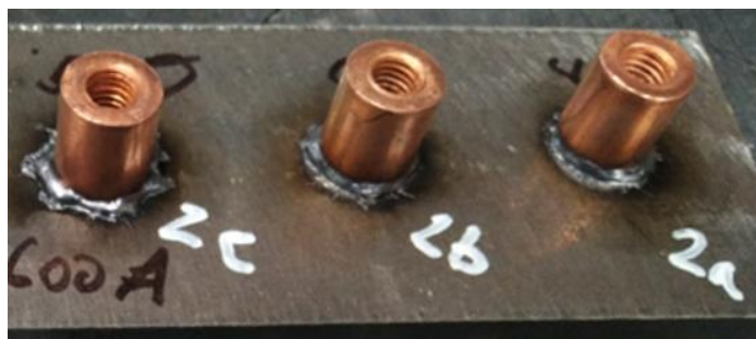
Obrázek 67: Čepy 2a, 2b, 2c vizuálně. Poloha PA – optimalizace SRM
