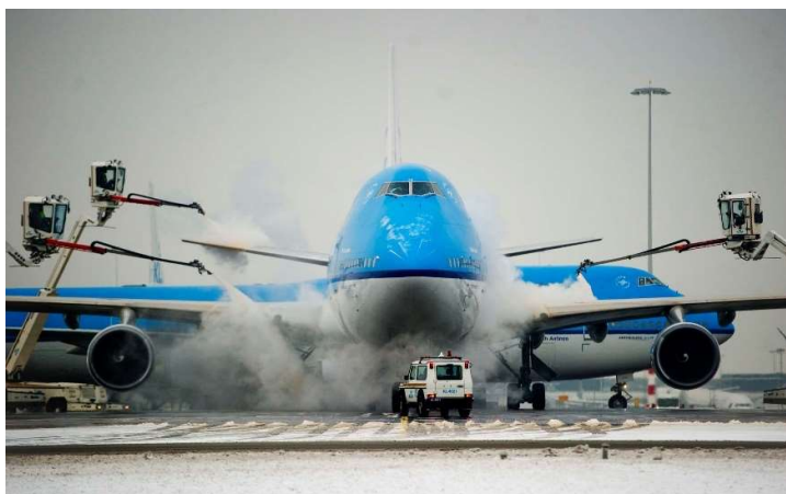
Obr. 14 Nanášení rozmrazovací kapaliny na Boeing 747-200 (Jumbo Jet) nizozemských aerolinek KLM Royal Dutch Airlines (převzato z [63])
