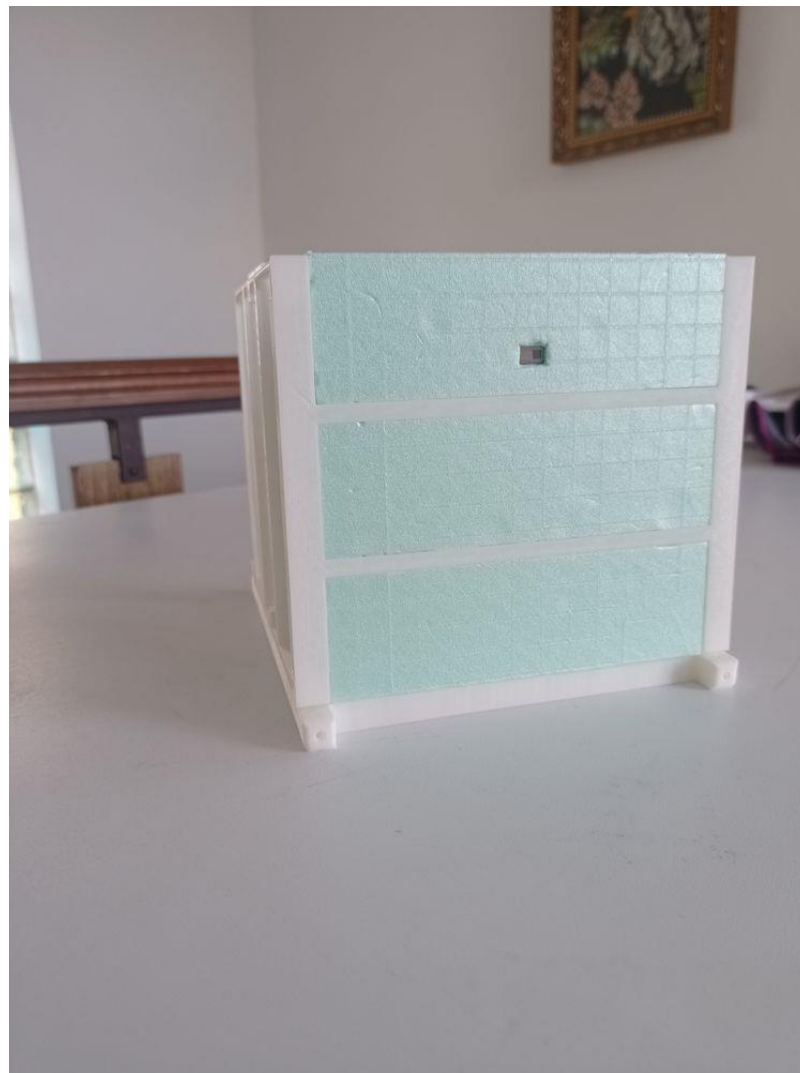
Obr. 27: Ukázka implementace IR senzoru a vývojového modulu WiPy 3.0 do jedné stěny sondy-vnější část.
