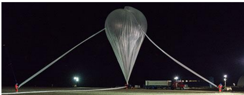
Obr. 2: Fóliový stratosférický balón (převzato z [6]).
