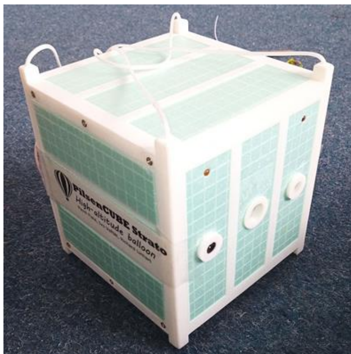
Obr. 9: Balónová sonda PilsenCUBE-Strato v plné velikosti 15 cm x 15 cm x 15 cm (převzato z [14]).
