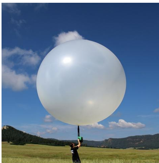
Obr. 3: Ukázka pryžového meteorologického balónu (převzato z [10]).
