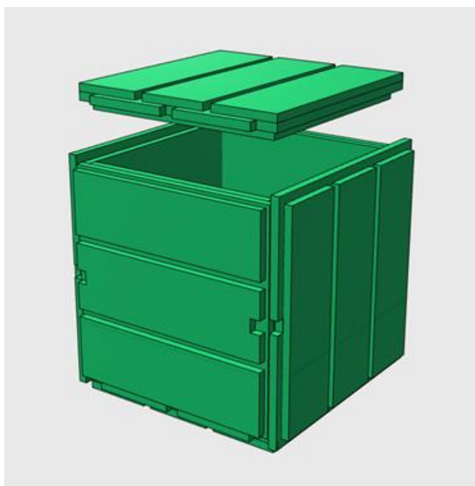
Obr. 11: 3D model slepených stěn z extrudovaného polystyrenu (převzato z [14]).
