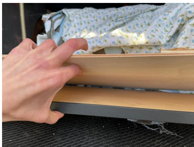
Obrázek 21 – Zkouška, hrana olepna ABS hranou, tl.2mm (archiv autora)
