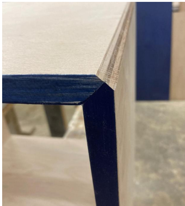
Obrázek 25 a 26 – Ukazka moření vrchní vnitřní plochy a obvodu celé komody (archiv autora)
