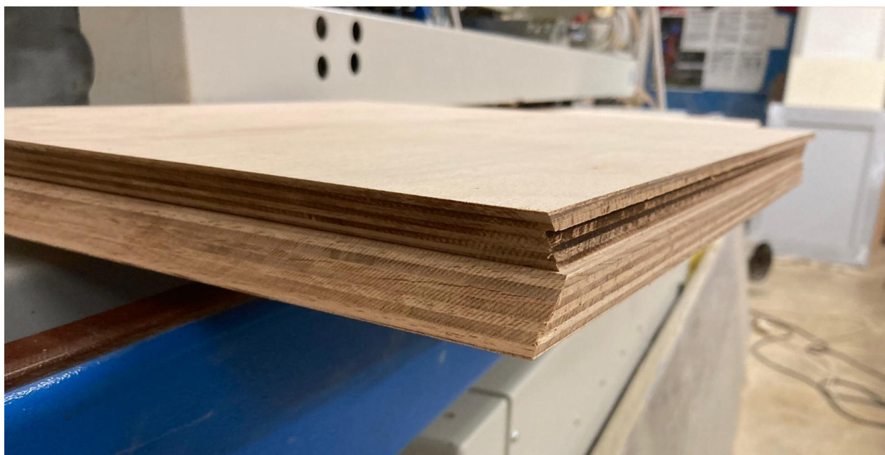
Obrázek 23 – Zkosení hran hlavní konstrukce (archiv autora)
