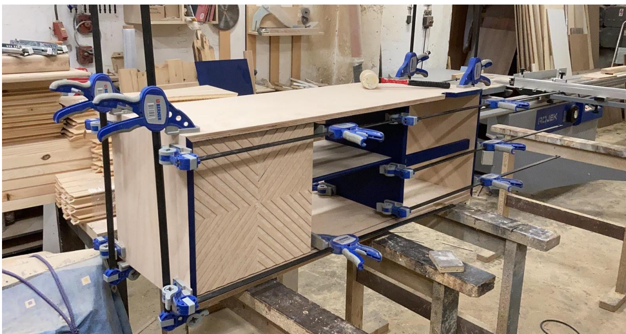
Obrázek 27 – Sušení celé konstrukce (archiv autora)
