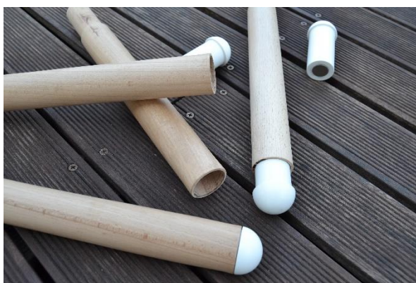
Obr. 23 - Vyfrézované dřevěné nohy a kovové zátky (archiv autora)
