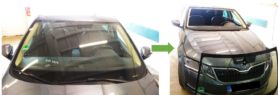
Obrázek 4-34: Demontáž čelního skla
