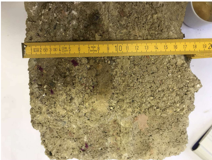
Obr.5.2.10.d – Lehce zbarvení v 20 mm od kraje vzorků-pohled shora
