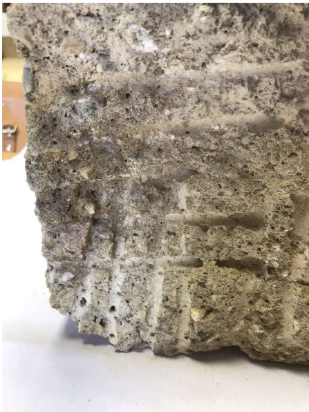
Obr.5.2.10.f a 5.2.10.g – Beton se nezabarvil – pohled z boku
