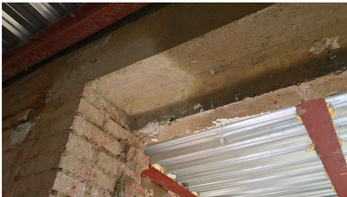
Obr.5.2.9.i – Aplikace fenolftalienu – beton se nezabarvil
