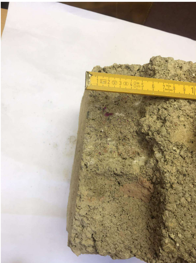
Obr.5.2.10.e – Lehce zbarvení v 20 mm od kraje vzorků-pohled shora
