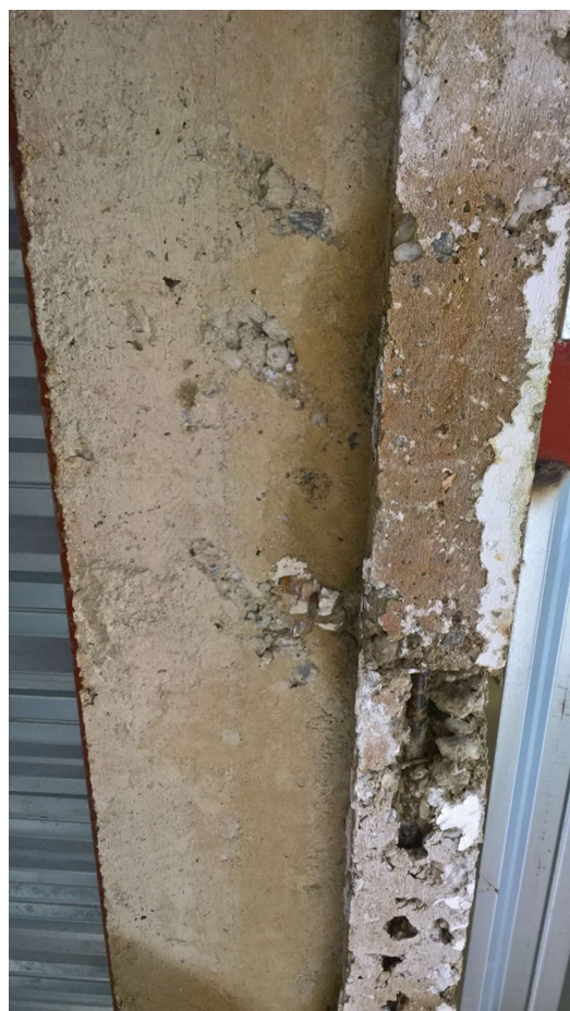
Obr.5.2.9.g a 5.2.9.h – Sonda č.2 – Aplikace fenolftalienu- pohled zespodu
