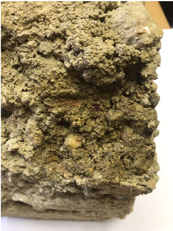
Obr. 5.2.10.h a 5.2.10.i – beton se nezabarvil v miste bývalé výztuže
