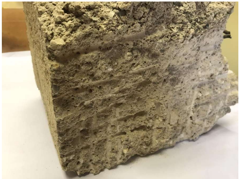
Obr.5.2.10.f a 5.2.10.g – Beton se nezabarvil – pohled z boku
