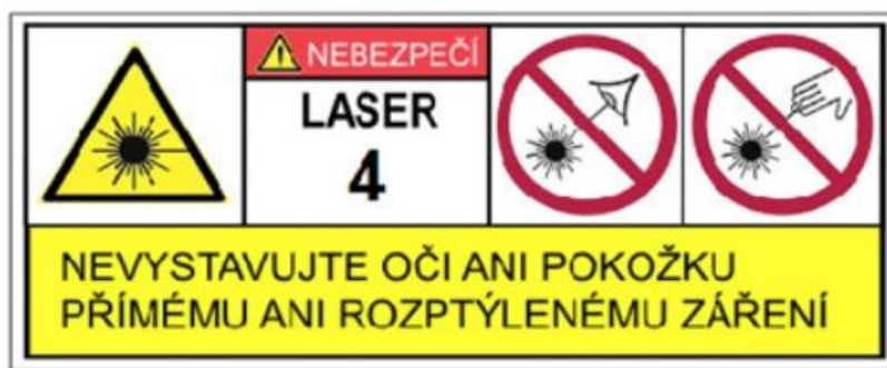
Obr. 24 možné označení laseru třídy 4 (převzato z [6])
