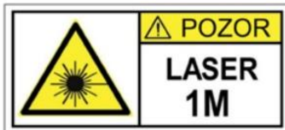
Obr. 18 možné označení laseru třídy 1M (převzato z [6])
