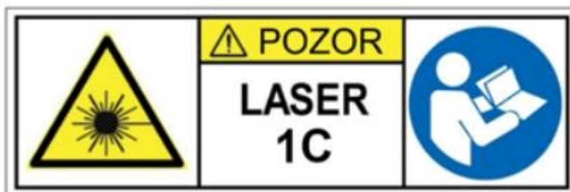
Obr. 19 možné označení laseru třídy 1C (převzato z [6])
