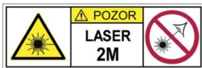
Obr. 21 možné označení laseru třídy 2M (převzato z [6])
