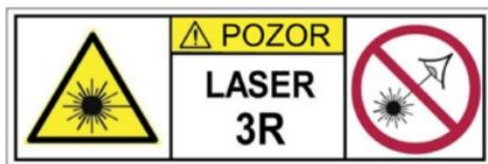
Obr. 22 možné označení laseru třídy 3R (převzato z [6])
