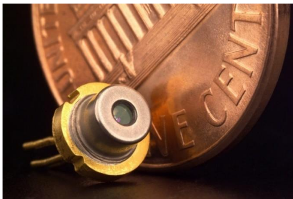
Obr. 7 velikost laserové diody v porovnání s mincí (dolarový cent) (převzato z [13])
