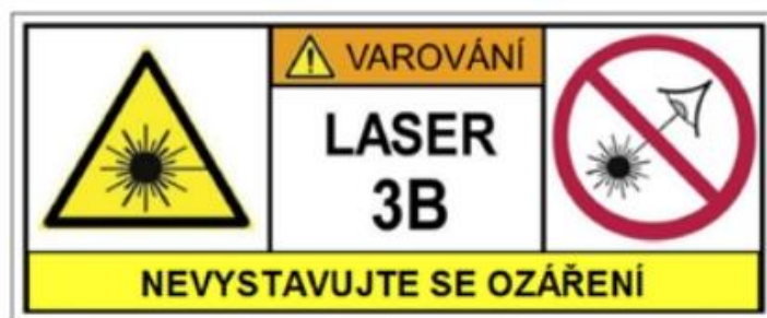
Obr. 23 možné označení laseru třídy 3B (převzato z [6])
