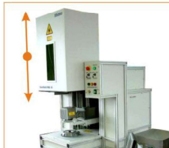
Zobrazení úniku záření mechanicky pohyblivým krytem
