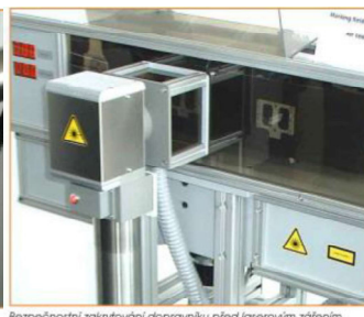
Bezpečnostní zakrytování dopravníku před laserovým zářením
