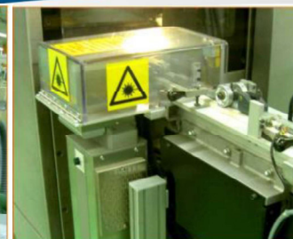
Bezpečnostní zakrytování nad dopravníkem s adekvátním popisem
