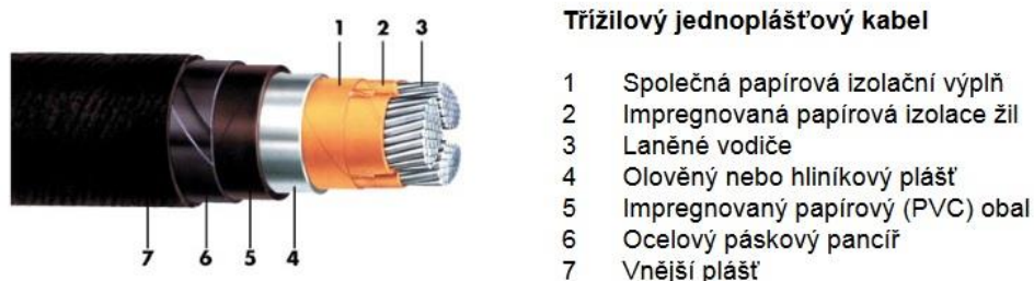
Obr. 2. Popis vrstev jednoplášťového kabelu (převzato z [8])
