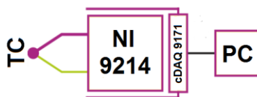
Obr. 4-7 – schéma měření teplot s osazeným termočlánkem
