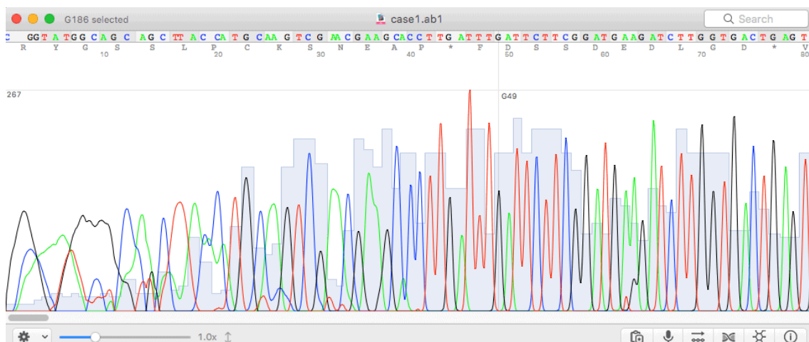
Obrázek 11: Data ve formátu ab1 . V levé části vidíme nekvalitní data. Nízká kvalita dat se vyskytuje nejčastěji v částech s introny. [49]
