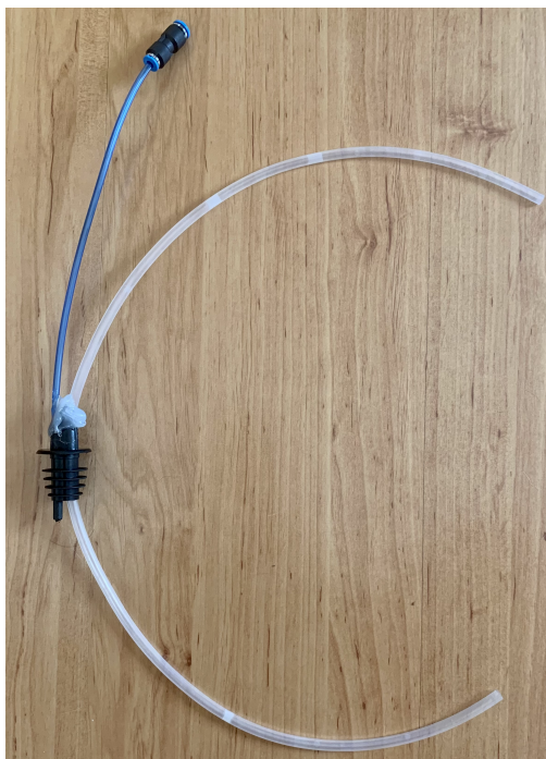
Obrázek 42: Ukázka utěsněného barmanského nalévátka s provlečenými hadičkami.
