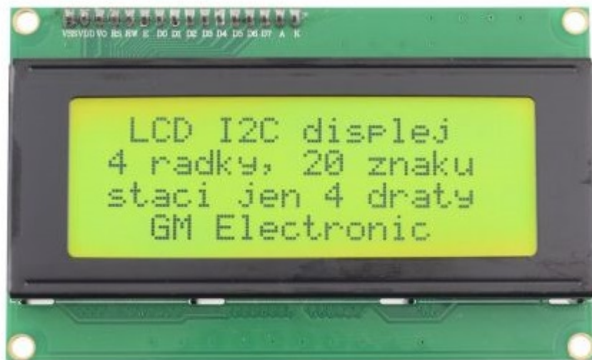
Obrázek 31: LCD displej 20x4 se sběrnici I 2 C, žlutozelený, výrobce: GM Electronic ([59])
