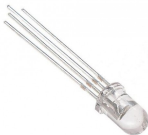
Obrázek 28: RGB LED dioda se čtyřmi vývody - tři pro barvy a jeden pro zem od firmy: Kitronik Ltd ([35]).
