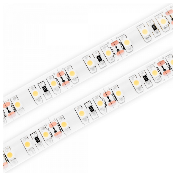
Obrázek 32: Voděodolný 12V RGB pásek osazený LED čipy 3528 od firmy NEONICA Polska Sp ([36]).
