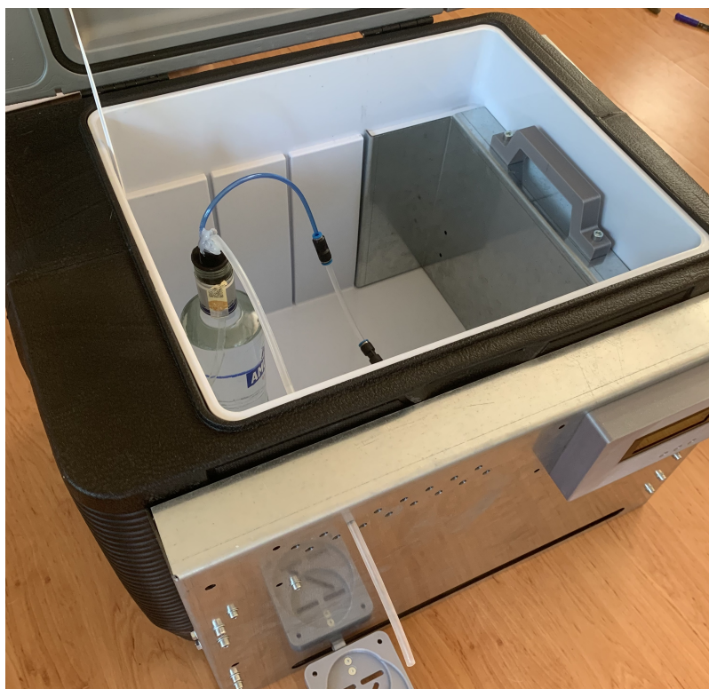
Obrázek 46: Ukázka vzduchového rozvodu v lednici, napojení na láhev s vývodem pro kapalinu.
