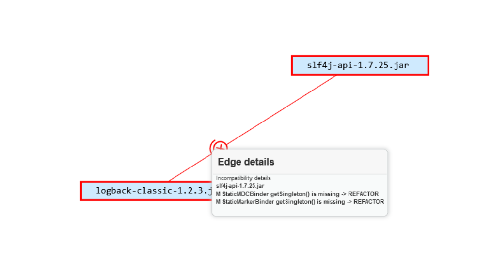
Obrázek 15: Zobrazení příčiny nekompatibility v detailu hrany
