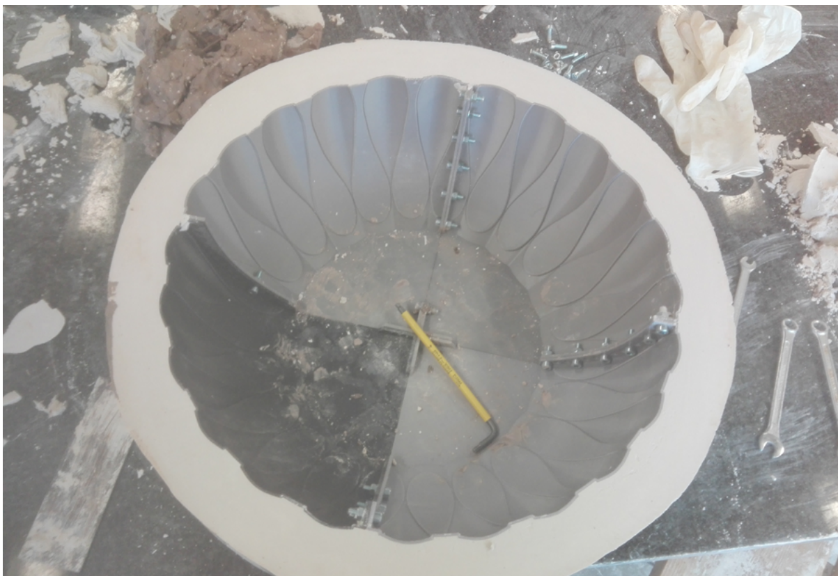
Obr.39 výroba misky Čestmír - 3D model spojený šrouby zalitý ve vnějším dílu sádrové formy
