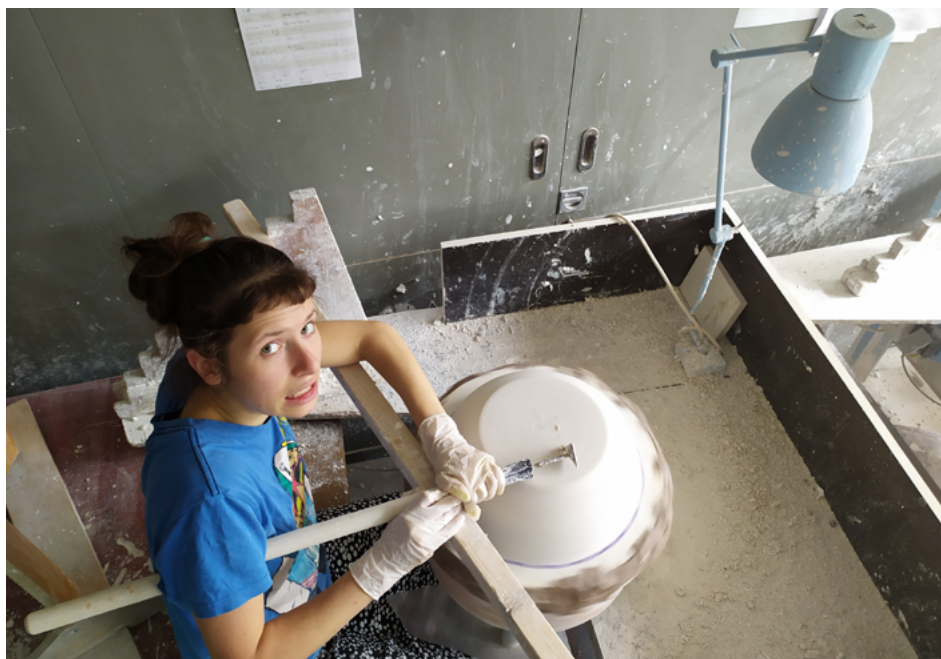
Obr.40 výroba mísy Čestmír - stáčení jádra (vnitřní části formy) na sádrařském kruhu (průměr 360 mm)
