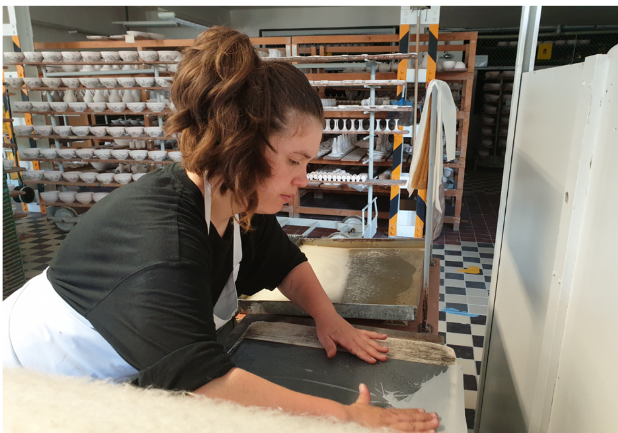
Obr. 53 Porcelánka v Dubí, nanášení tenkého přenosového papíru
