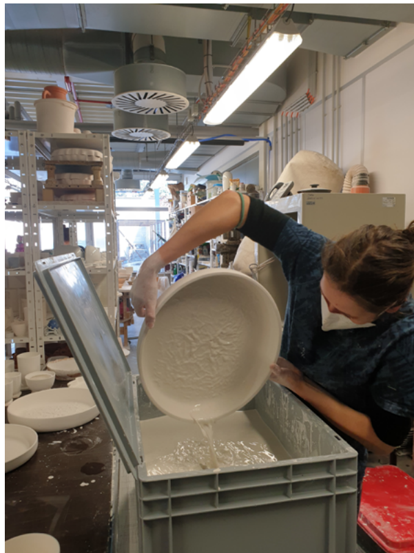
Obr.38 glazování zapékací misky Václav
