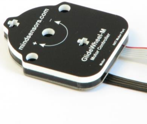
Obr. 3.4 Enkodér GlideWheel navržený pro použití s LEGO motory (převzato z [27])
