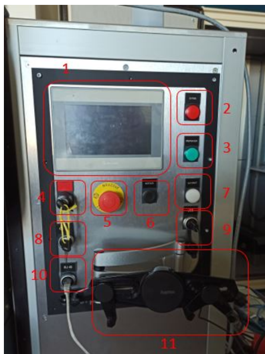
Obrázek 8.3: Na tomto obrázku jsou zobrazeny všechny části ovládacího panelu k použitému rehabilitačnímu robotovi. Jednotlivé oblasti jsou popsány čísly: 1) Hlavní dotyková obrazovka, pomocí které se nastavují různé parametry při měření. 2) Tlačítko "Chyba"- Pokud svítí, tak je stroj zastaven a vyžaduje pozornost. 3) Tlačítko "Připraven"- indukuje připravenost k zapnutí cvičení. 4) Klíček sloužící pro odblokování bezpečnostního režimu. 5) Tlačítko "Total STOP"slouží k nouzovému vypnutí robota. 6) Tlačítko "Kvítace"se využívá pro potvrzení chybového stavu. 7) Kontrolka automatického režimu. 8) Tlačítko "Vypínání"slouží pro přepnutí do režimu automat. 9) USB konektor pro nabíjení tabletu. 10) RJ45 konektor sloužící pouze pro servisní účely. 11) Držák tabletu.
