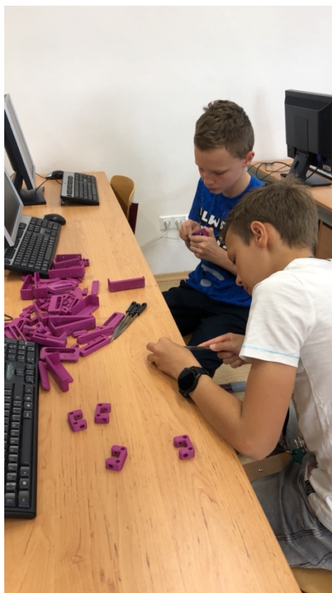
Obrázek 10 - povrchová úprava 3D výtisků pomocí pilníků
