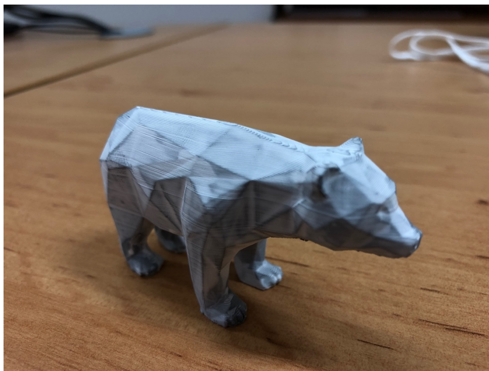
Obrázek 8 - sprej nanesený na 3D objekt
