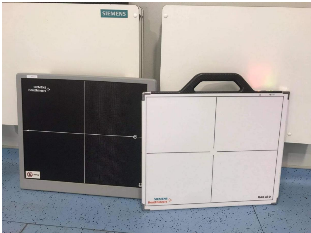
Obrázek 5: Flat panel s nepohyblivou protirozptylovou mřížkou (Lisholmova mřížka)
