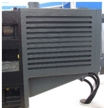
Obr. 37 Původní tvar chladících žebířů na koště – vlevo model, vpravo reálná kostra
