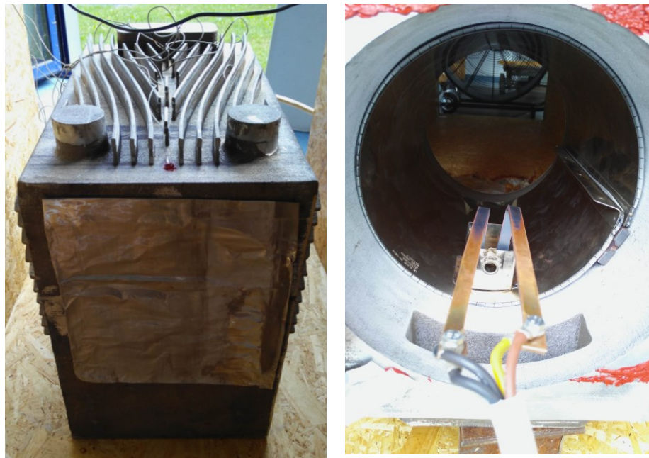
Obr. 73 Fotky z experimentu (vlevo zakrytování, vpravo pohled na topnou spirálu)
