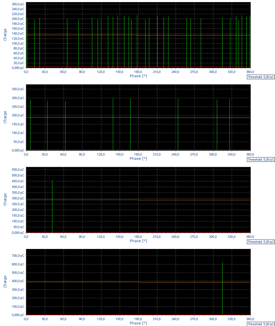
Obr 3.31 Pulzní diagram měřené DCP korony (odshora U=4,5 kV; U=5,5 kV, U=6 kV, U=6,5 kV)
