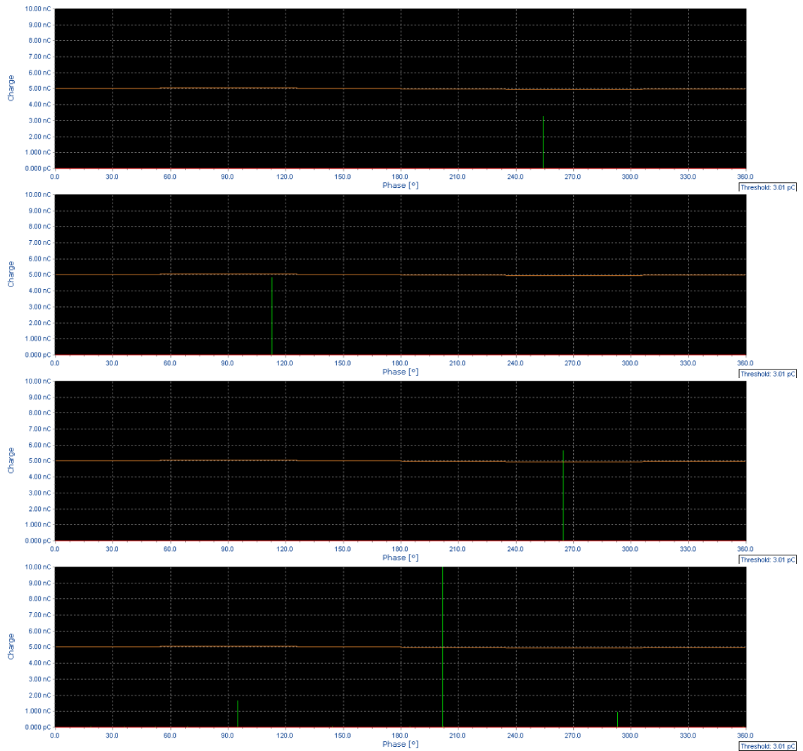
Obr 3.37 Pulzní diagram měřených DCP povrchových výbojů (odshora U=13 kV; U=16 kV, U=19 kV, U=22 kV)
