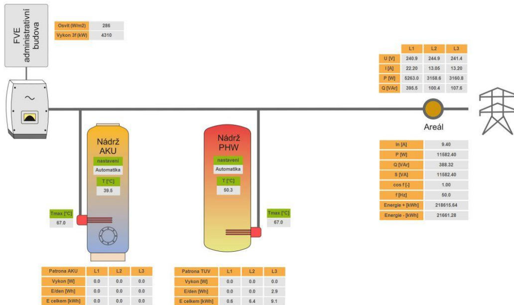
Obr. 3.17 Uživatelské rozhraní pro regulaci přetoků FVE do odporových patron
