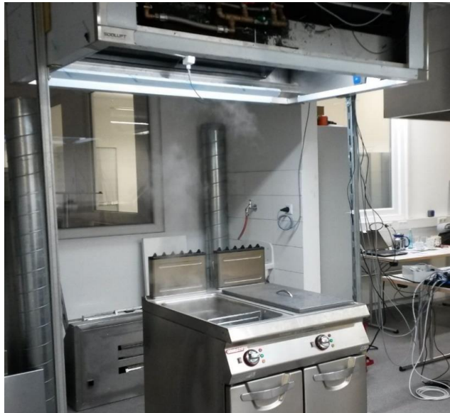
Obr. 2.17 Měření rekuperační jednotky v laboratorních podmínkách
