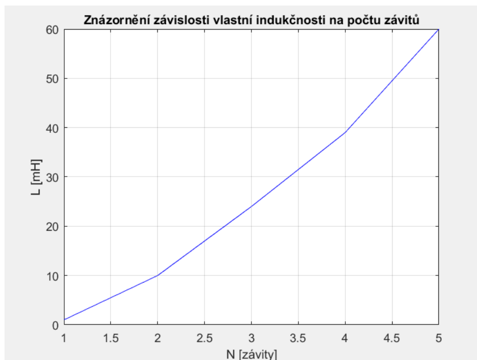
Obrázek 22: Grafické znázornění závislosti indukčnosti na zvyšujícím se počtu závitů N pro cívky se vzdáleností l_1 = 150 mm vytvořené v programu Matlab
