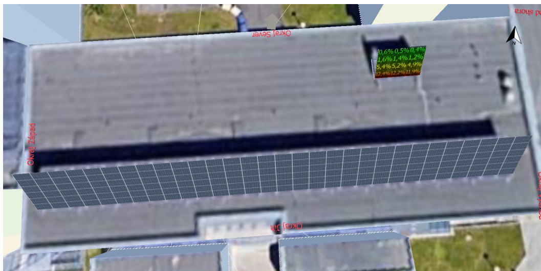
Obr. 7.6: Simulace zastínění modulů v programu PV*SOL
