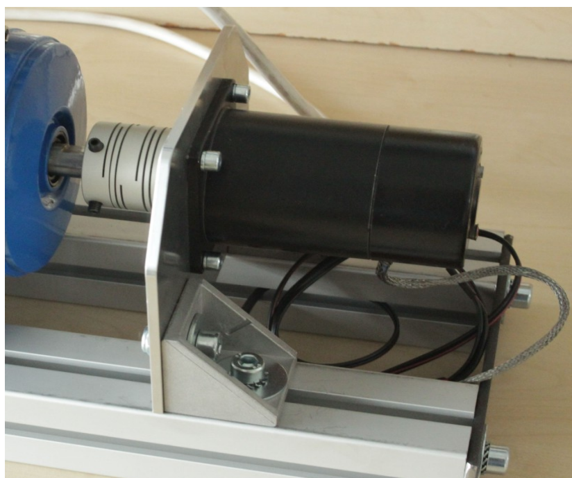
Obr. 26: Fotografie uchycení tachodynamu v konstrukci přípravku
