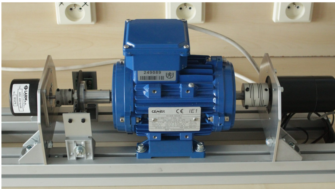
Obr. 27: Zdroj točivého momentu pro snímače, v koncepci finálního rozvržení měřicího přípravku otáček
