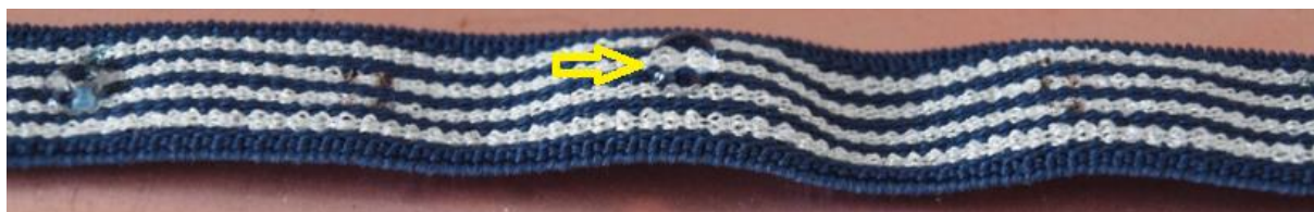
Obr. 34: Nanesené UV tvrditelné lepidlo Loctite AA 3926
