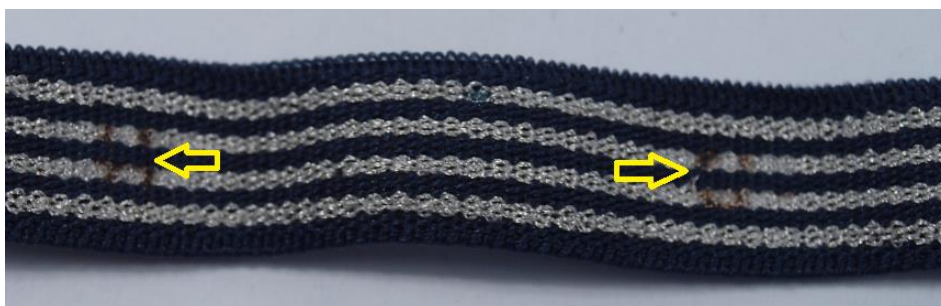
Obr. 24: Přerušené vodivé dráhy
