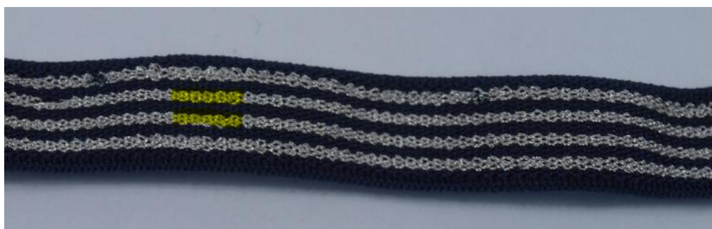
Obr. 22: Vodivá stuha s vyznačenými vodivými drahami
