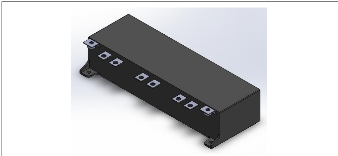
Obr. 39: 3D Model kondenzátorové baterie
