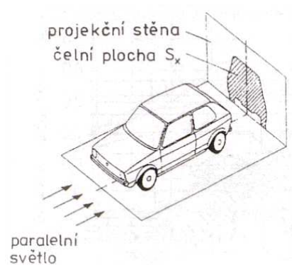
Obrázek 2.1: Způsob měření čelní plochy vozidla |Převzato z [1]|
