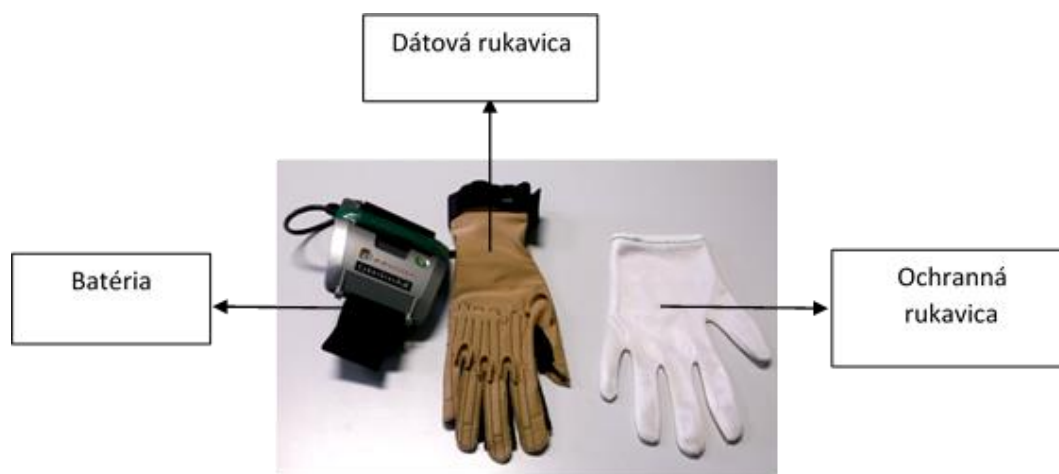
Obr. 2 - Dátová rukavica CyberGlove II
