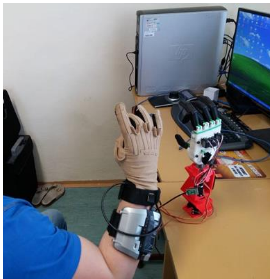
Obr. 9 - Systém prepojenia virtuálnej reality a robota [1]
