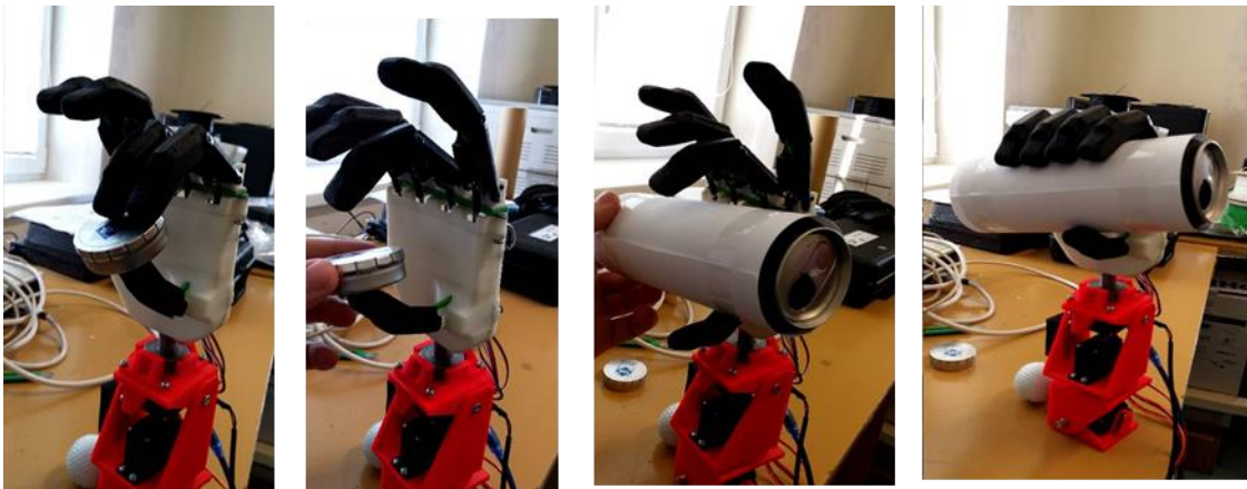
Obr. 10 - Príklady z experimentálneho laboratórneho overovania činnosti robotickkej ruky [1]
