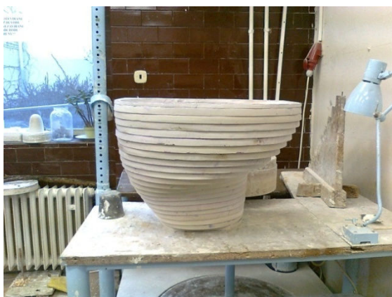
Obr. 3 model ze sádrových desek [Foto vlastní]
