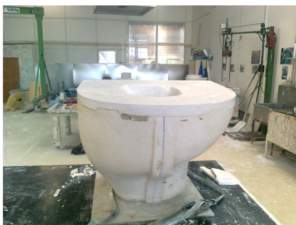
Obr. 21 Hotové pláště a jádro [Foto vlastní]
