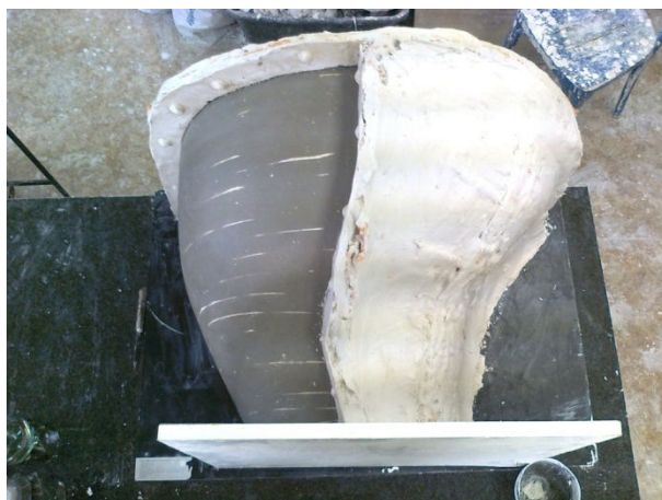
Obr. 7 Tvorba blint formy [Foto vlastní]
