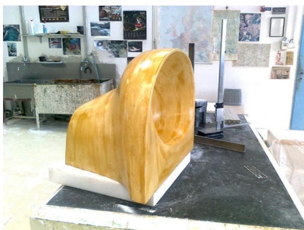
Obr. 12 Model natřený šelakem [Foto vlastní]
