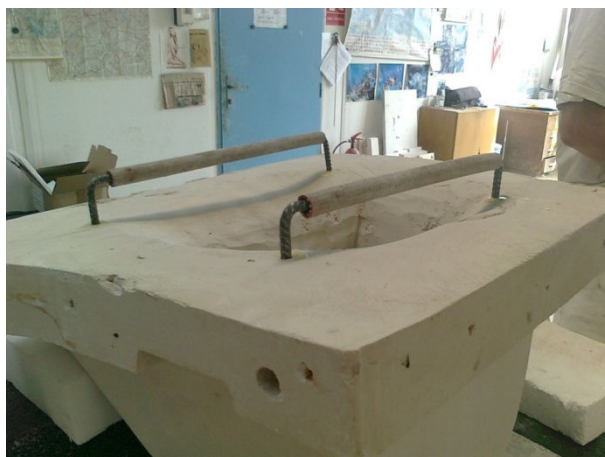
Obr. 34 Madla na zadním díle formy [Foto vlastní]
