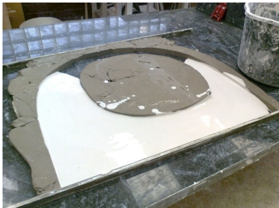
Obr. 1 Hliněná šablona na desku [Foto vlastní]
