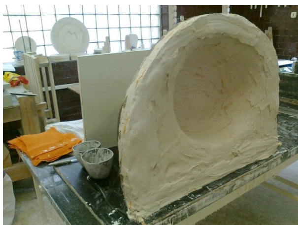
Obr. 5 První díl blint formy
