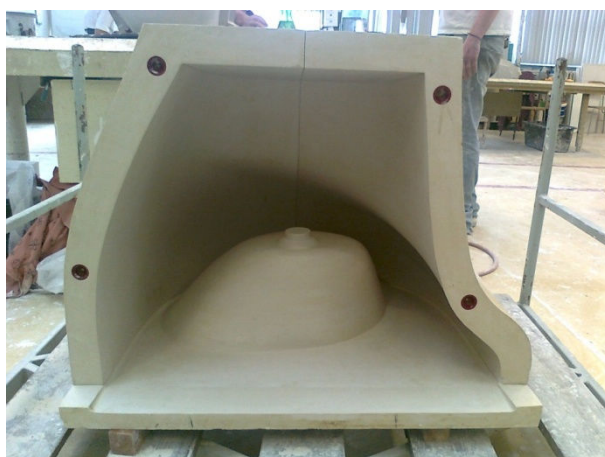
Obr. 32 Začištěné pláště a jádro [Foto vlastní]
