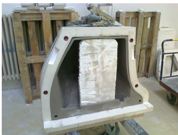
Obr. 39 Polystyren zabraňující deformaci [Foto vlastní]
