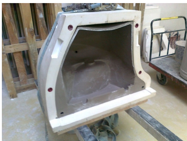
Obr. 38 Odlitek ve formě [Foto vlastní]
