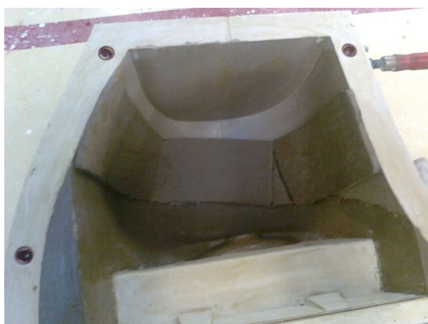
Obr. 27 Střepování [Foto vlastní]
