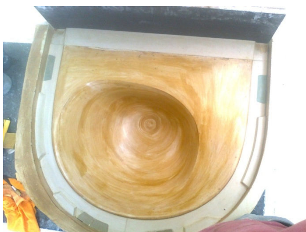
Obr. 20 Zámky a hmatáky na jádře [Foto vlastní]
