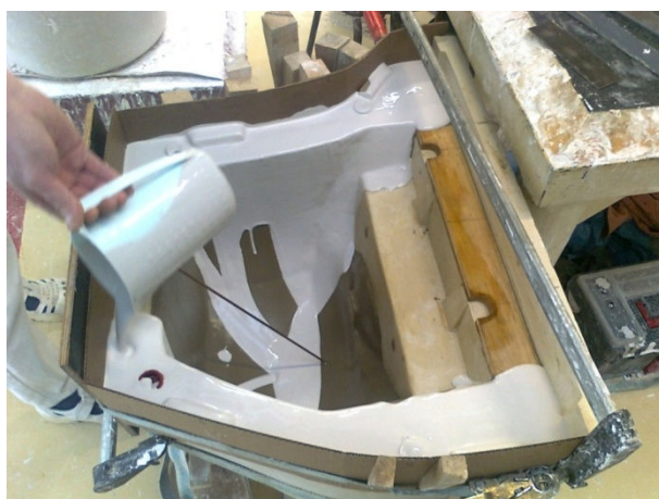
Obr. 29 Lití zadního dílu s klínem [Foto vlastní]
