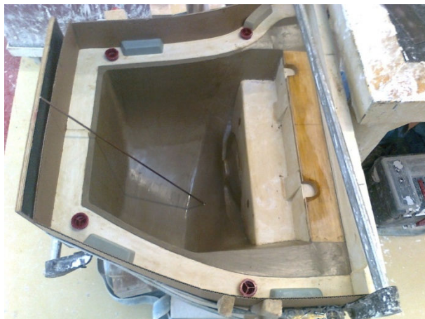
Obr. 28 Hotové střepování [Foto vlastní]
