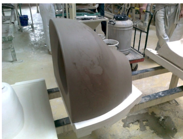
Obr. 42 Hotový odlitek [Foto vlastní]
