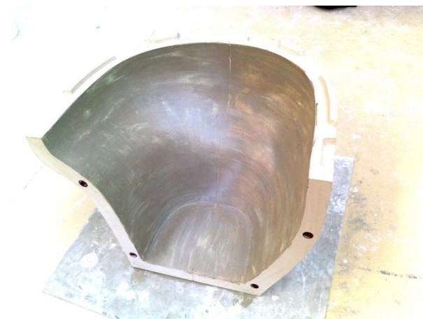
Obr. 22 Pláště neseparované šlikou a mýdlem [Foto vlastní]
