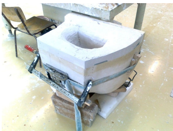
Obr. 30 Hotový zadní díl formy [Foto vlastní]
