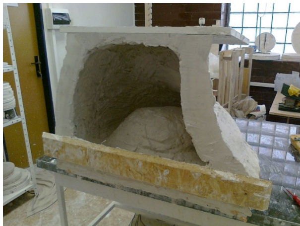
Obr. 10 Model v blint formě [Foto vlastní]
