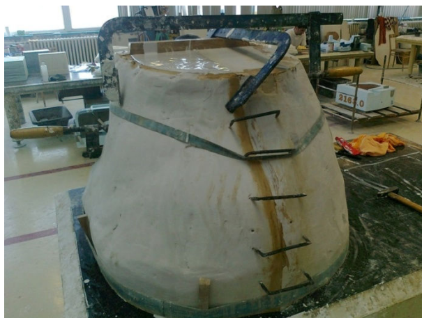
Obr. 19 Zalití druhého dílu formy [Foto vlastní]
