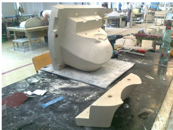
Obr. 31 Úprava zadního dílu formy a malého klínu [Foto vlastní]
