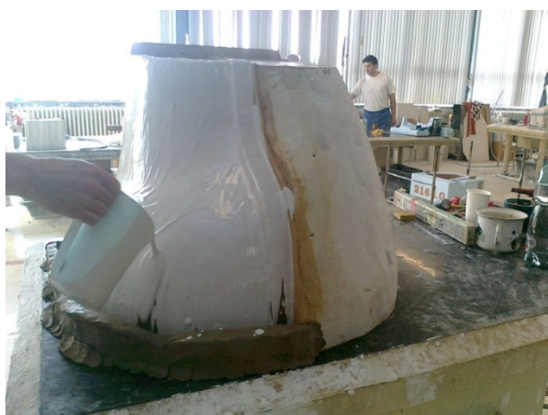
Obr. 18 Lití pomocné formy na formu [Foto vlastní]
