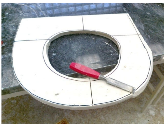
Obr. 2 Sádrová deska s vrstevnicemi [Foto vlastní]
