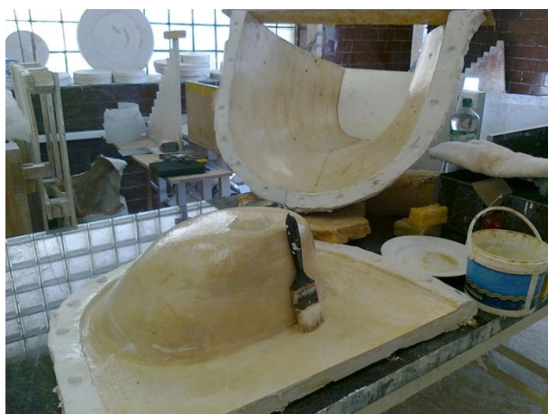
Obr. 8 Separace blint formy [Foto vlastní]
