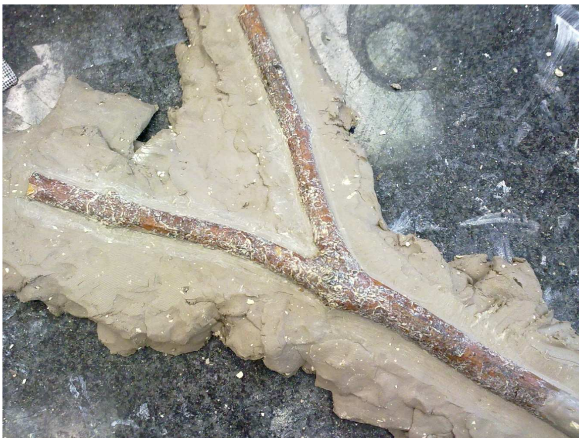
Dělicí rovina vytvořená z hlíny. [foto vlastní]
