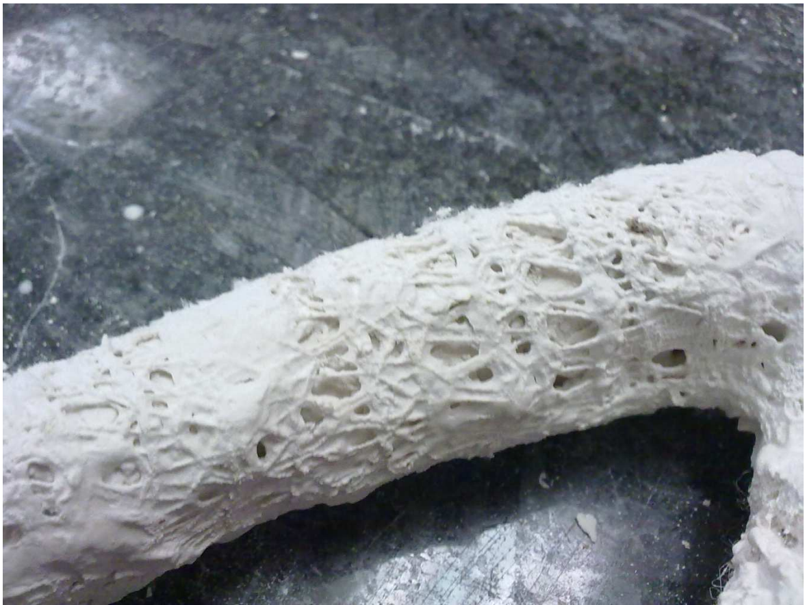
Sádrový model obalený do obvazu namočeného v sádře. [foto vlastní]
