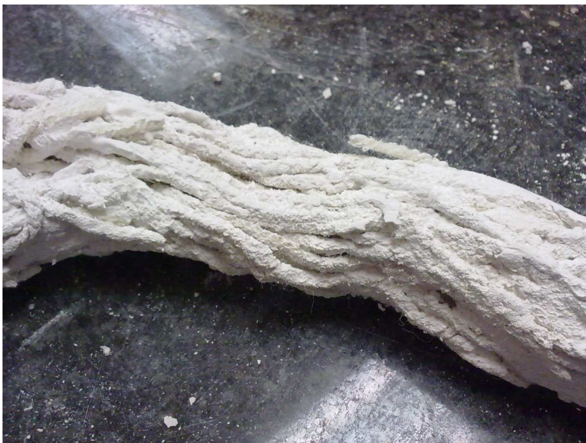
Sádrový model obalený bavlnkou namočenou v sádře. [foto vlastní]
