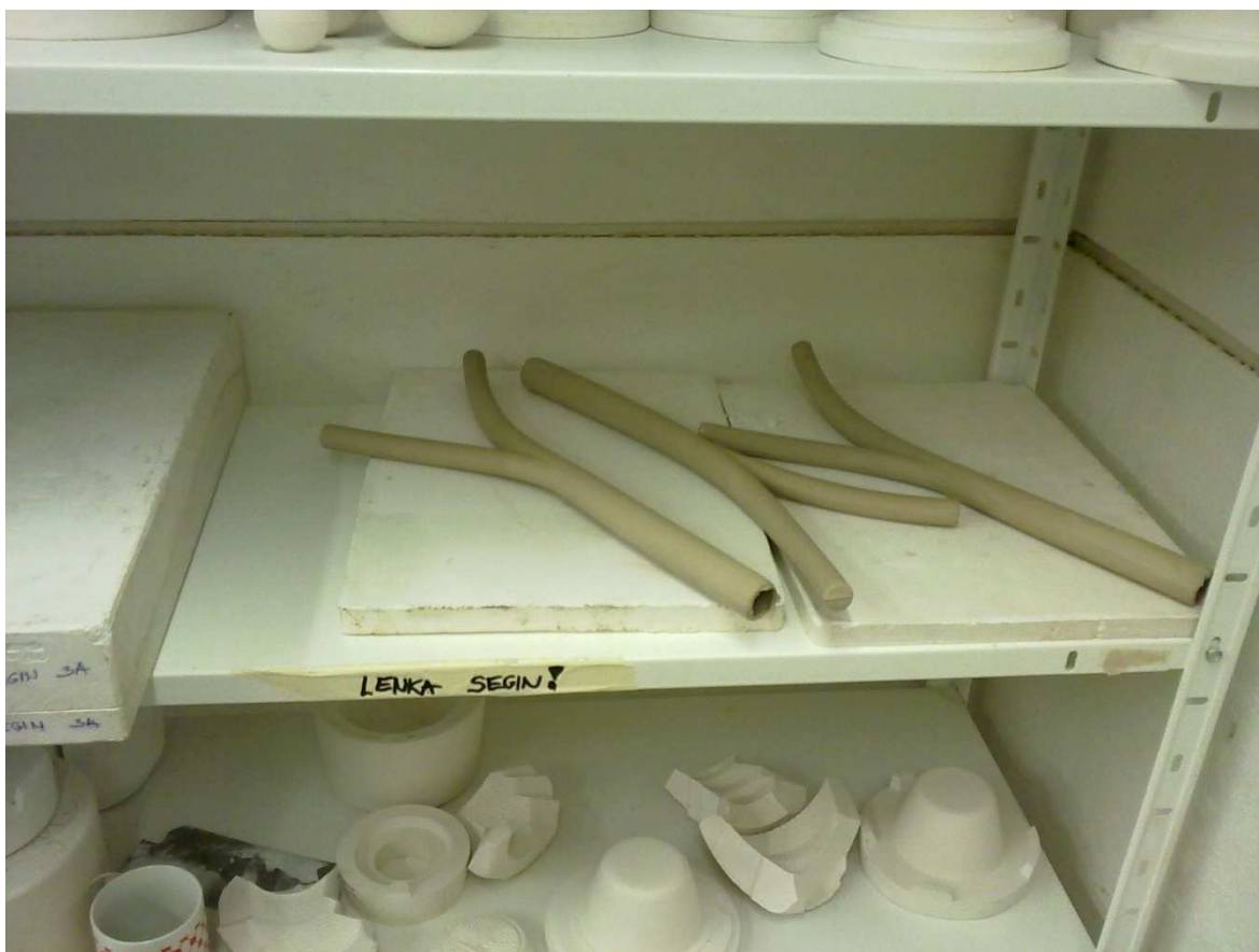
Schnoucí porcelán na sádrové podložce. [foto vlastní]
