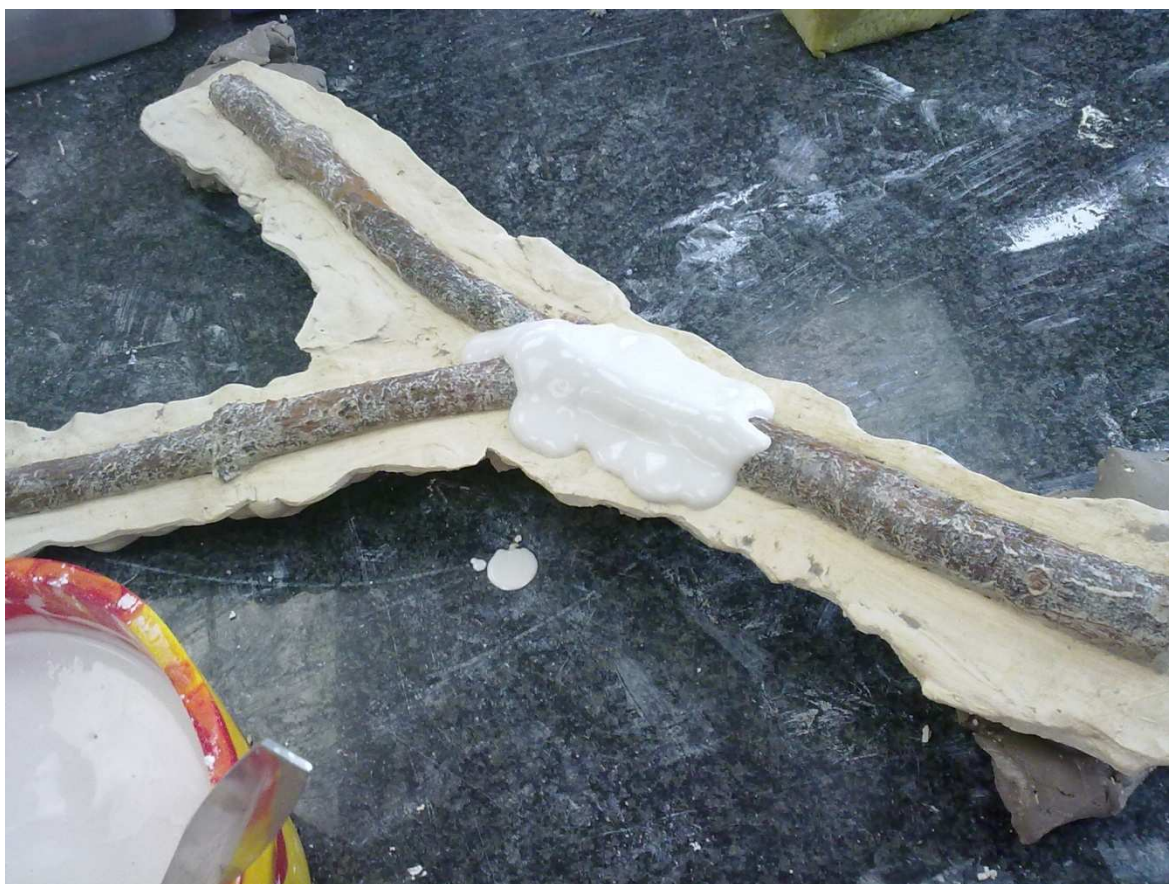
Výroba druhého dílu slepé sádrové formy. [foto vlastní]
