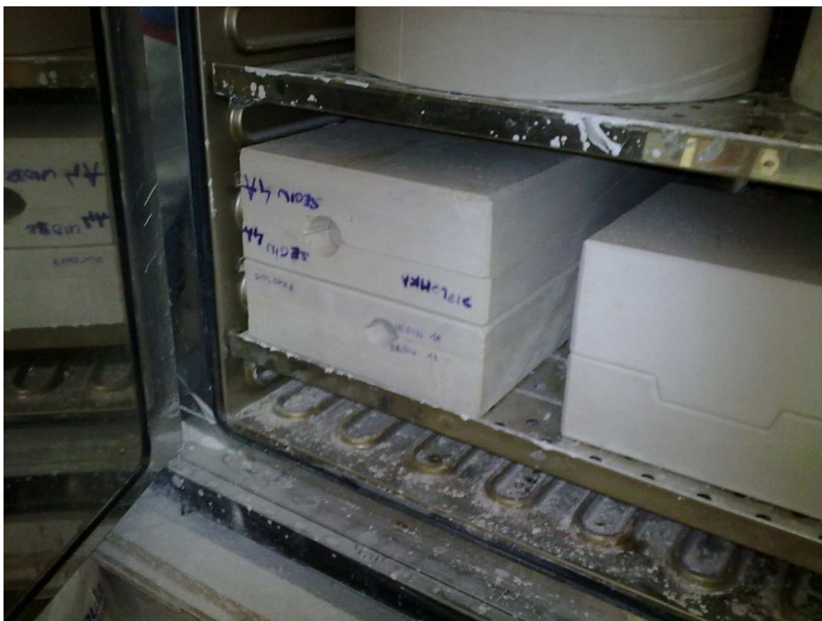
Formy uložené v sušárně. [foto vlastní]
