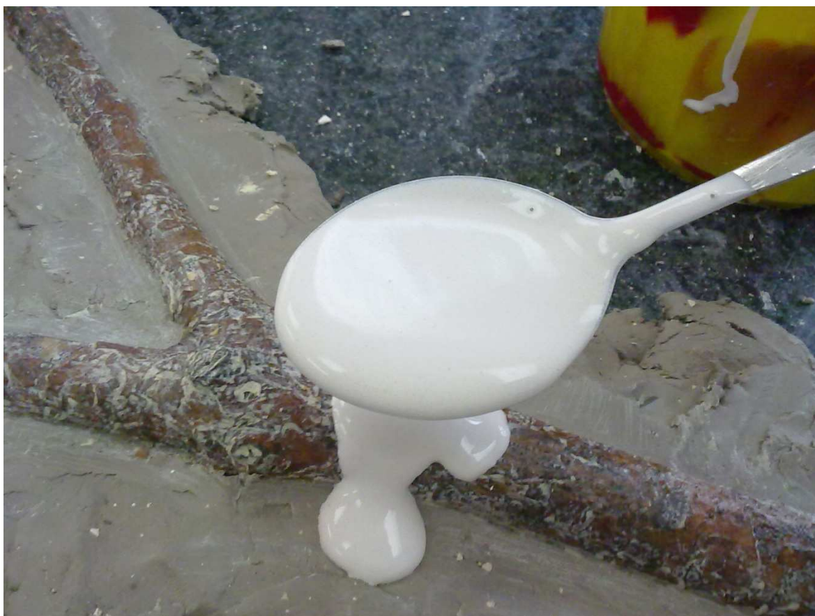
Nanášení slepé sádrové formy. [foto vlastní]
