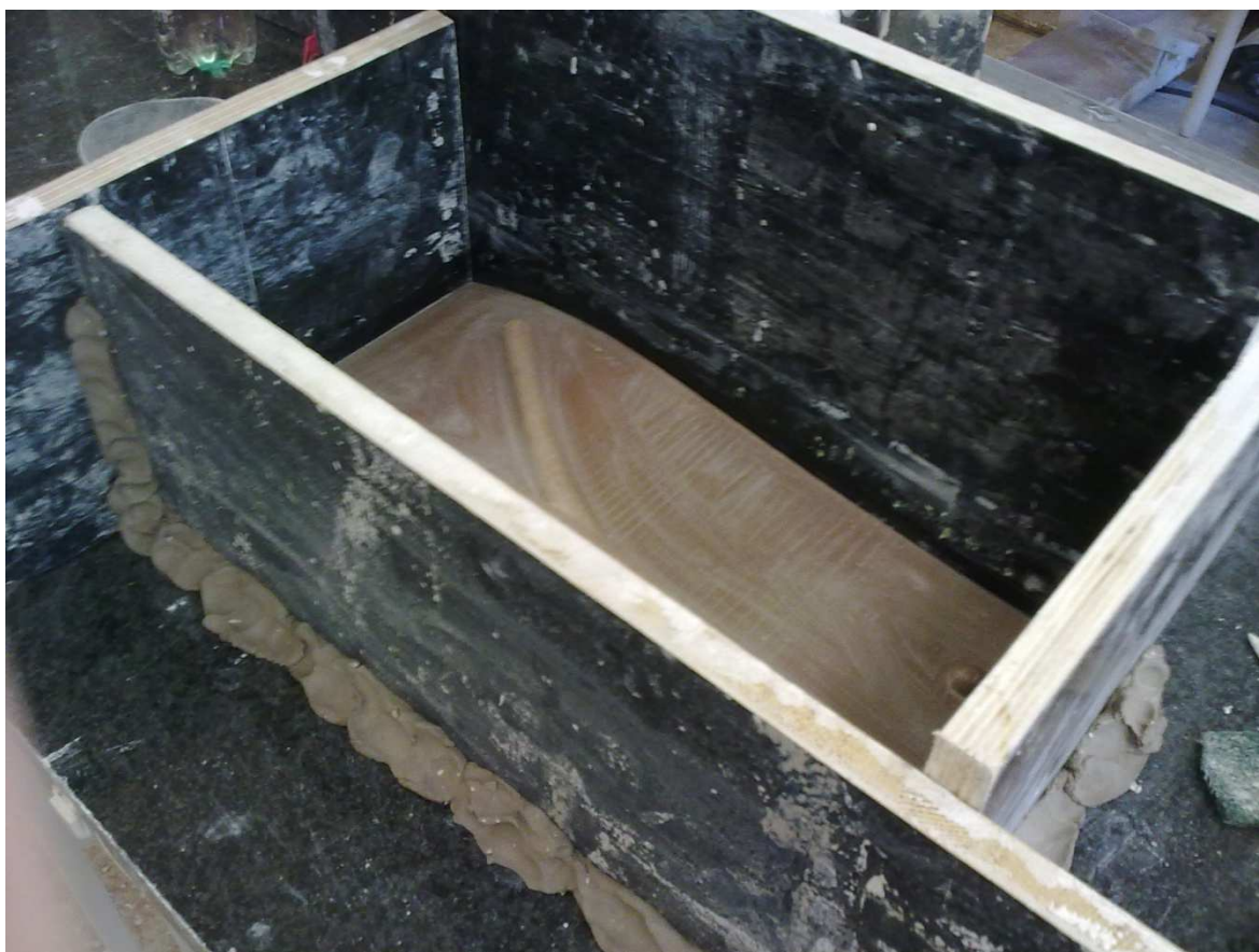
Ohrádka z desek upevněná hlínou. [foto vlastní]
