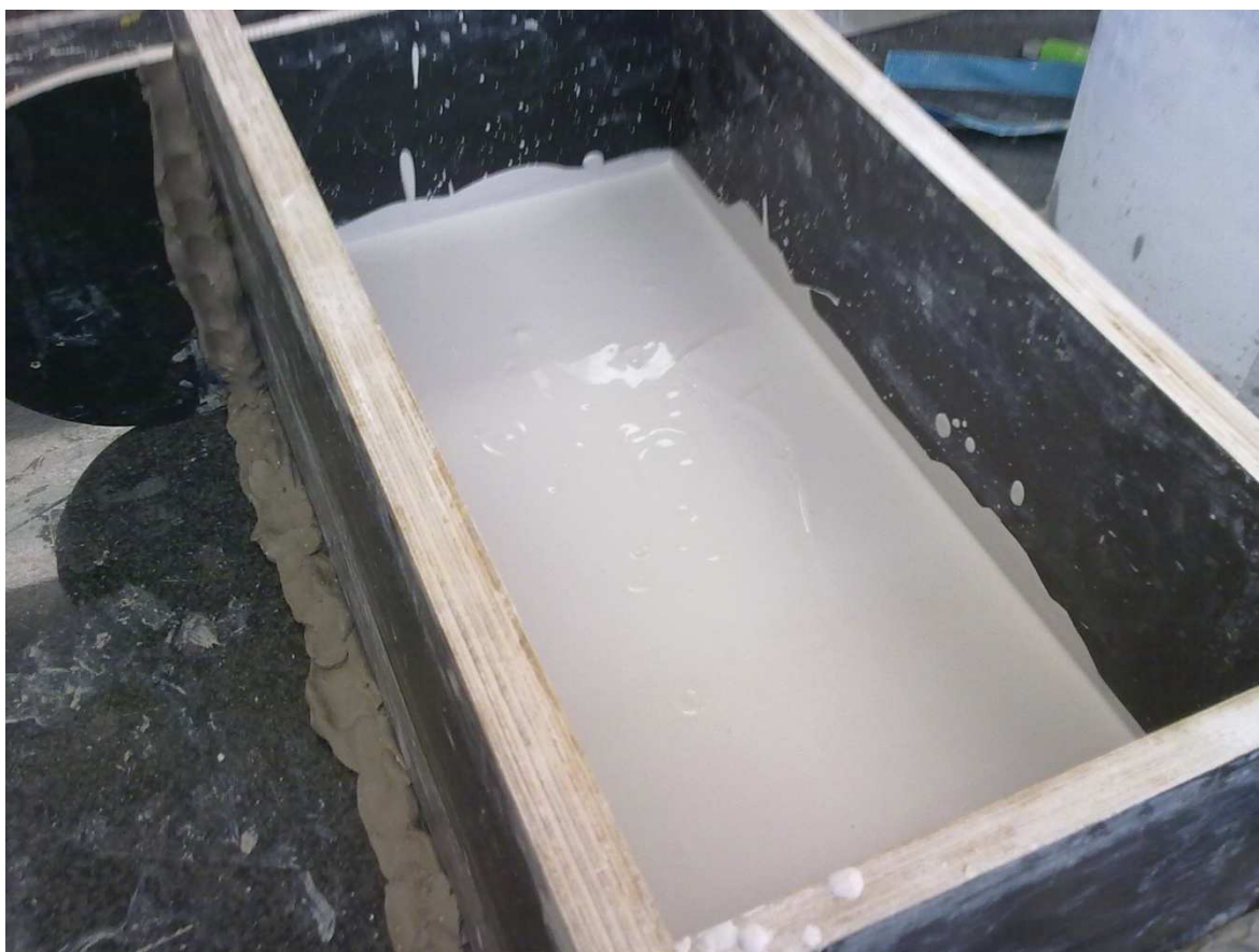
Zalítý spodní díl formy sádrovou hmotou. [foto vlastní]
