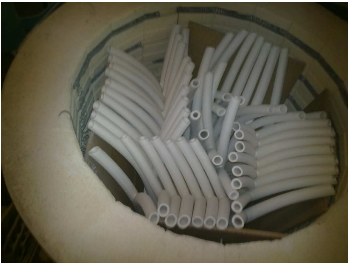
Naložená a připravená pec na přežah. [foto vlastní]
