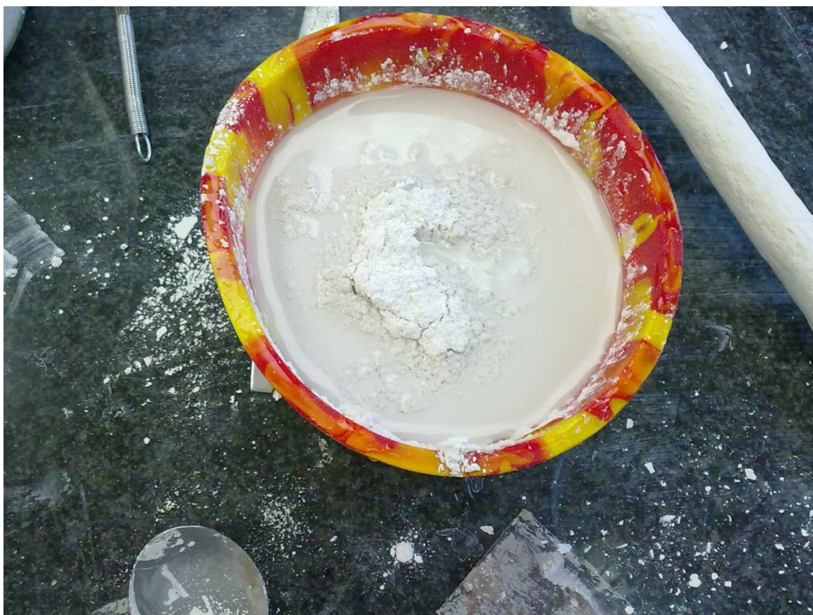
Přisypávání sádry pro následné použití. [foto vlastní]
