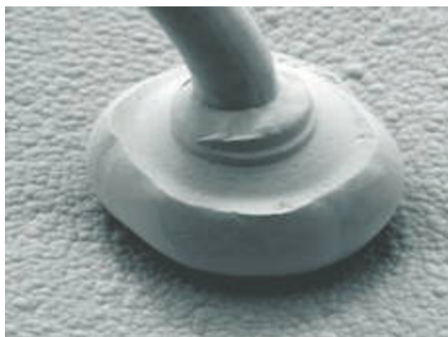
Obr. 2-4. Ukázka sváru, vytvořeného bondováním na kuličku. [3]
