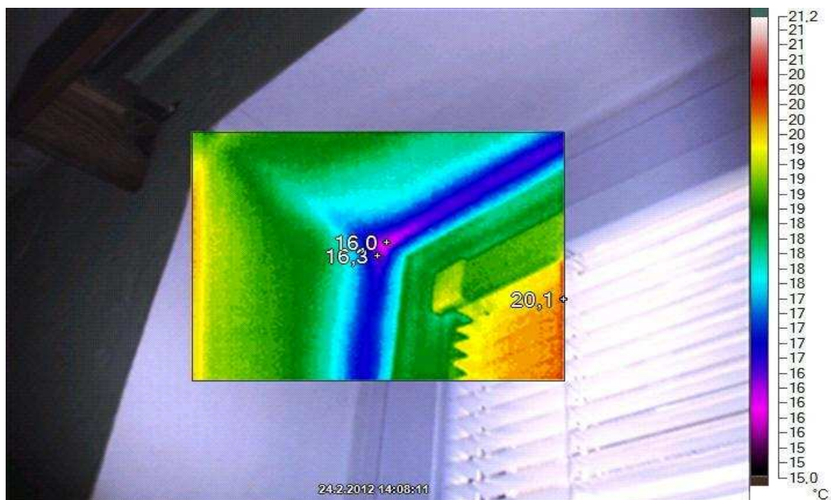
Obr. 2 Tepelný snímek nového plastového okna
