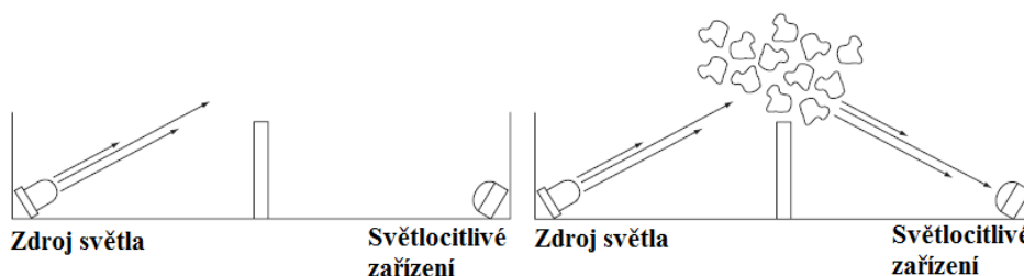
Obr. 3.2 Princip kouřového hlásiče [11]
