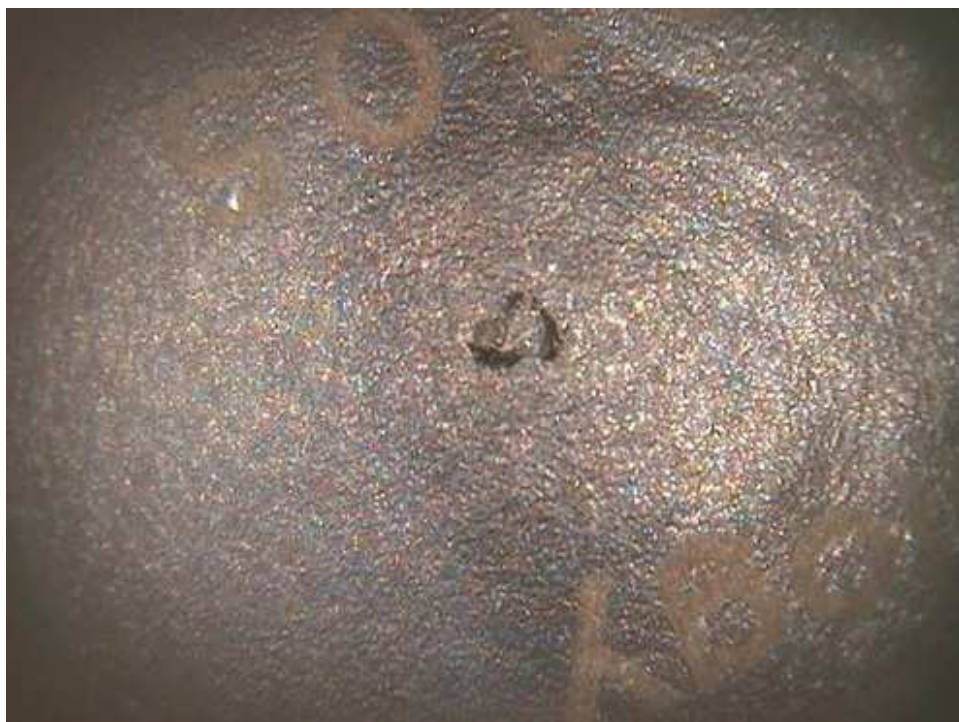
Obr. 16: Trhlina na spoji, příčinou může být vlhkost nebo také délka a teplota pájení (převzato z [14])
