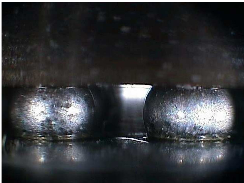
Obr. 14: Špatné smáčitelnost na povrchu DPS, příčinou může být vlhkost (převzato z [14])
