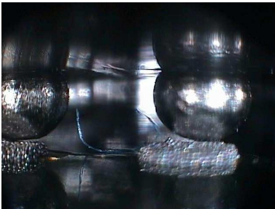
Obr. 12: Špatné připájení způsobené nečistotami a vlhkostí (převzato z [14])
