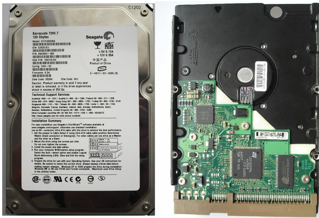
Obr. 4.2 HDD Seagate 7200.7 3,5", na pravém obrázku je vidět řídicí elektronika
