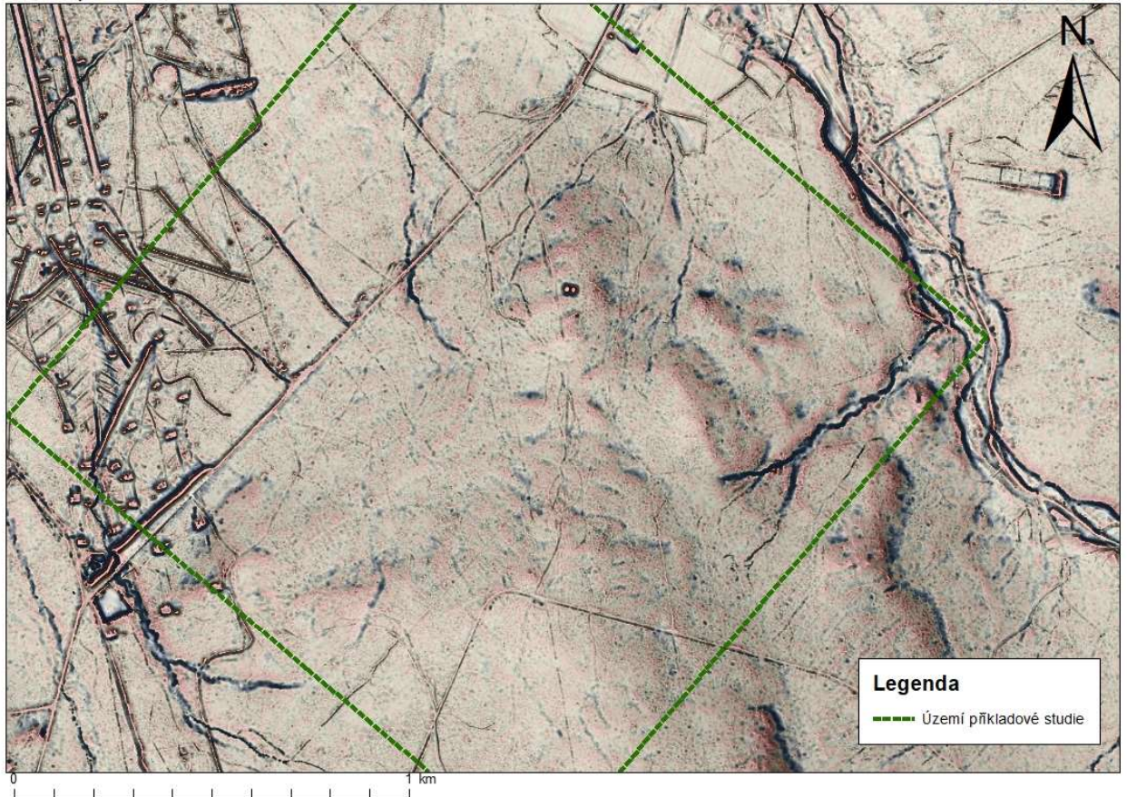
Obrázek 26: Kombinace vizualizací sky – view factor, local - relief model a positive openness. Autor: Tomáš Kroupa
