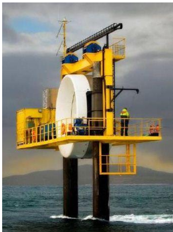
Obr. 3.19 Přílivová turbína v Orkney, Skotsko (převzato z [12])
