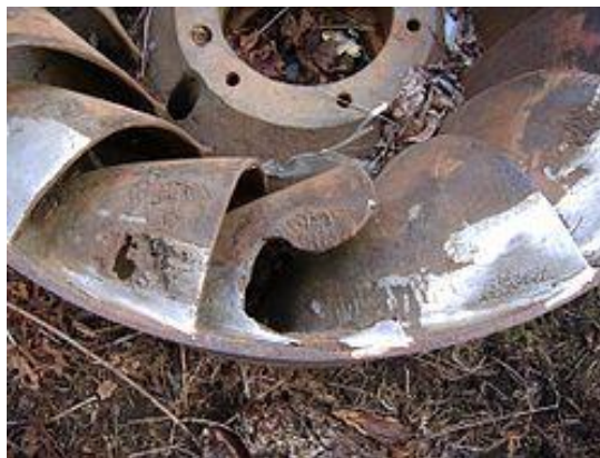
Obr. 9 Poškození Francisovy turbíny kavítací [69]
