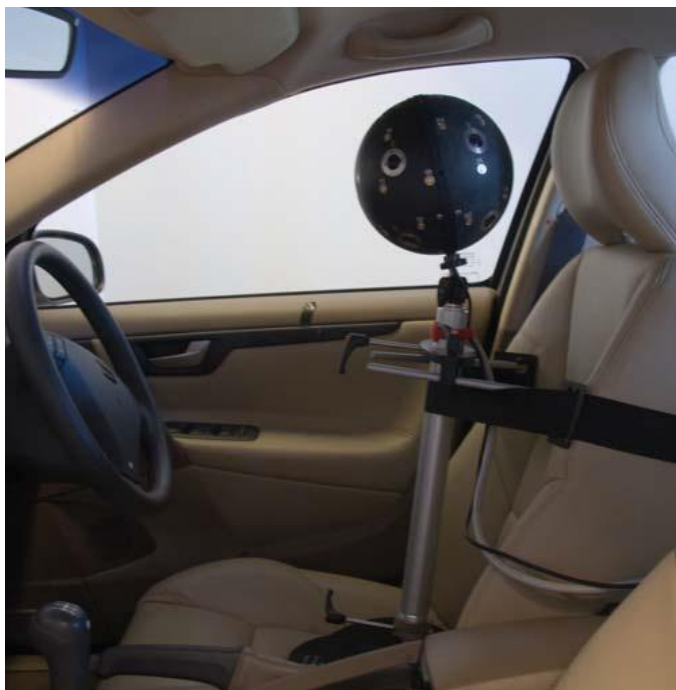
Obrázek 20 – Sférické pole při samotném měření interiéru vozidla (převzato z [23])
