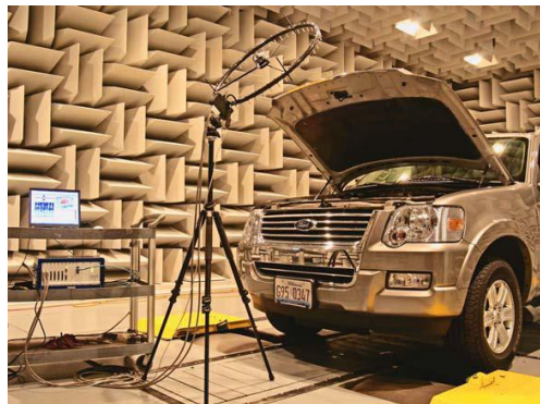
Obrázek 10 - měření automobilového motoru pomocí beamformingu (převzato z [14])
