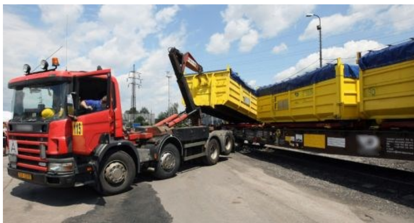
Obrázek 5: Překládka odvalovacích kontejnerů systému ACTS
