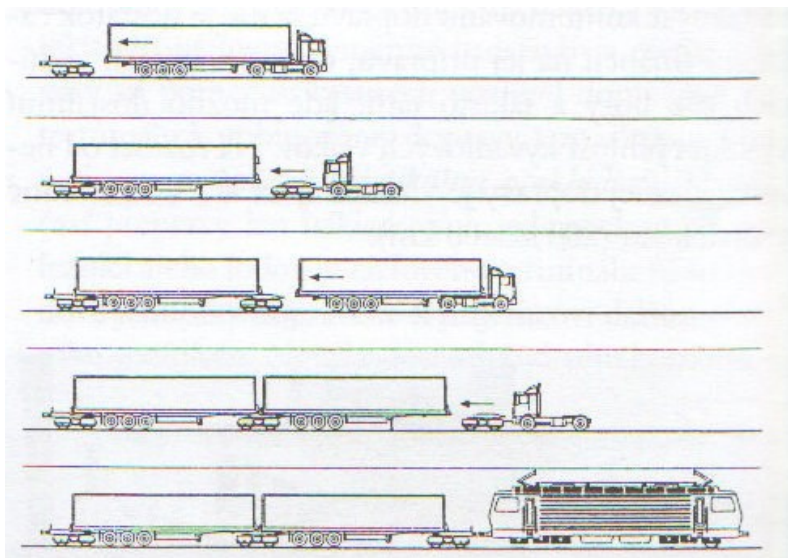
Obrázek 8: Způsob překládky systému podvojných návěsů
