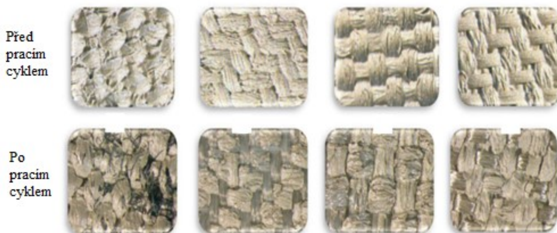
Obr. 21 Porovnání vodivé pasty po 20 cyklech praní. Převzato z: [105]
