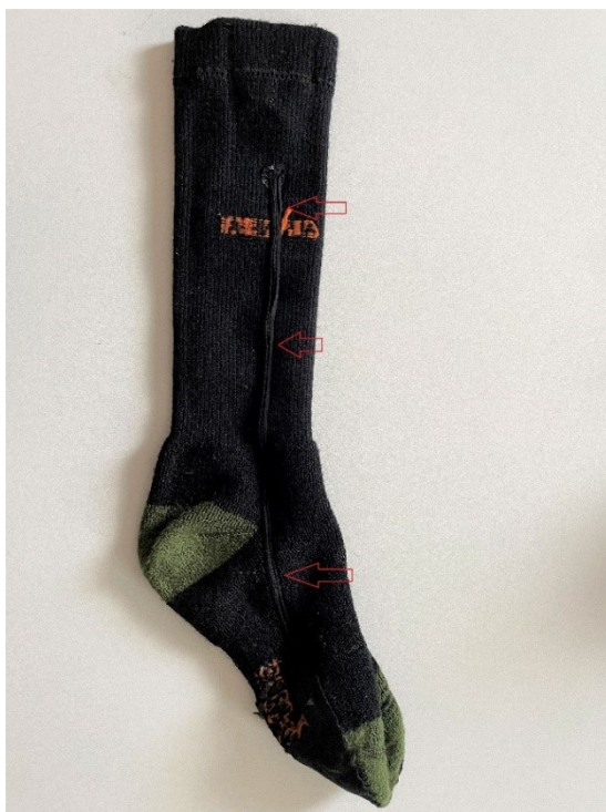
Obr. 27 Vodivá dráha dvou pinového měděného drátku s PVC izolace.
