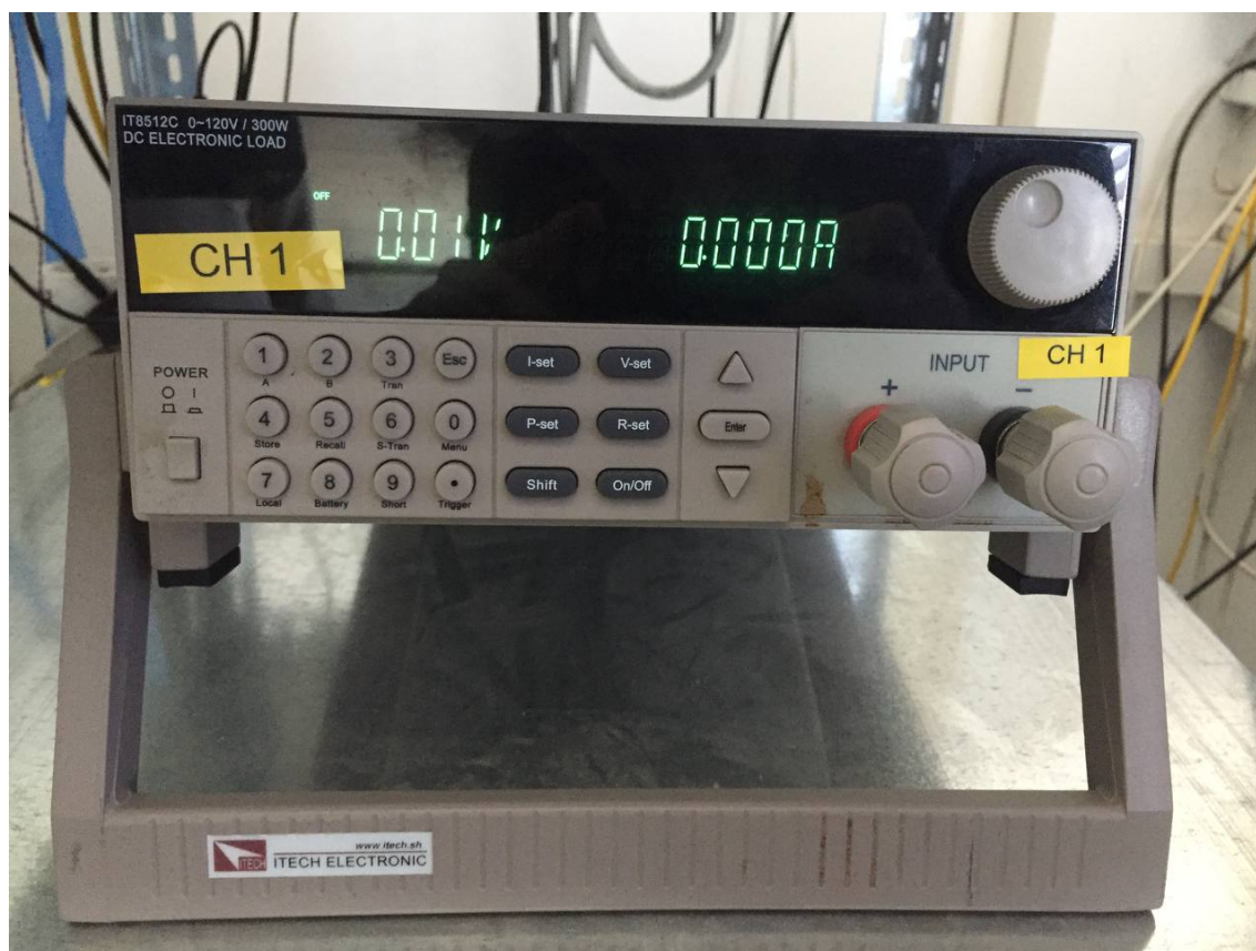
Obr. A.10: Elektronická programovatelná zátěž IT8512C.
