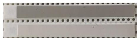
Obr. 22: Vzorky - pasta C 8717E (dole) a C1076SD (nahore) po sušení
