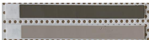
Obr. 21: Vzorky - pasta C 8717E (dole) a C1076SD (nahore) před sušením
