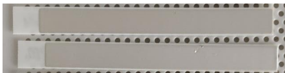
Obr. 23: Vzorky - pasta C 8717E (dole) a C1076SD (nahore) po výpalu
