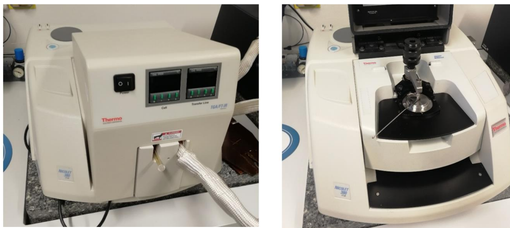
Obr. 15 Přístroj Nicolet 380 FTIR analýza plynů (Vlevo), FTIR ATR analýza (Vpravo)
