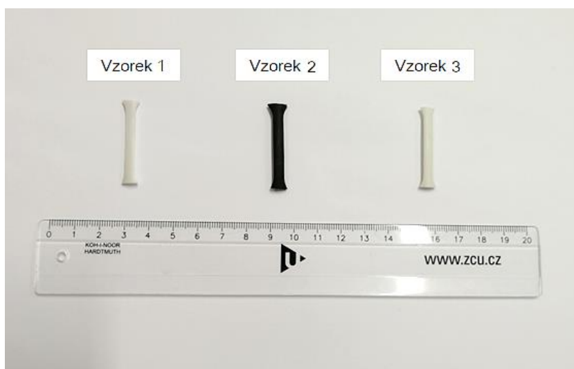
Obr. 20 DMA analýza - příprava vzorků (jednoduše vetknutý nosník)
