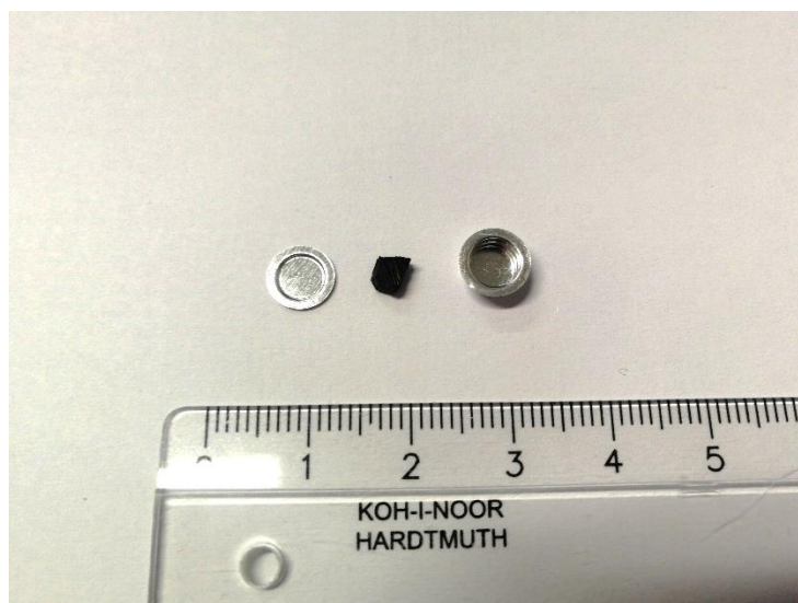
Obr. 17 DSC analýza - příprava vzorku (vzorek 2)
