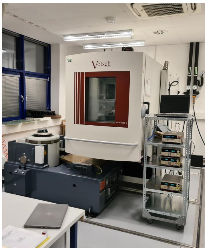
Obr. 21: Klimatická komora Vötsch VCV 3 7060-5.
