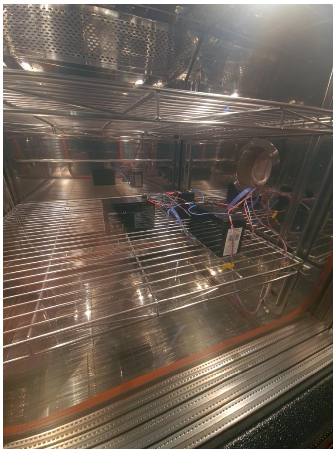
Obr. 20: Ukázka zapojení akumulátorů během testu.
