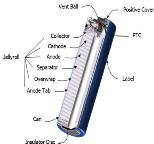
Obr. 8: Konstrukce FeS 2 -Li článku. Převzato z: [31].
