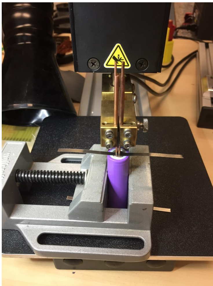
Obr. 15: Kontaktování vývodových plíšků na akumulátory pomocí odporového svařování.
